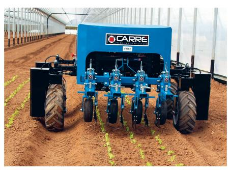
Le robot de sarclage « Anatis » de Carré est piloté par caméra et par GPS. Il fonctionne avec une batterie au lithium qui offre huit à dix heures d'autonomie et qui se recharge en trois heures. Photo: Carré
