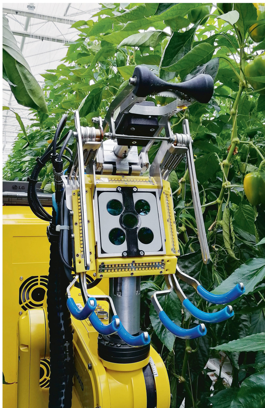
Le robot «Sweeper» est capable de cueillir les poivrons de manière autonome dans les serres grâce à une caméra 3D. Son «taux de réussite» avoisine actuellement les 62%. Photo: Idd
