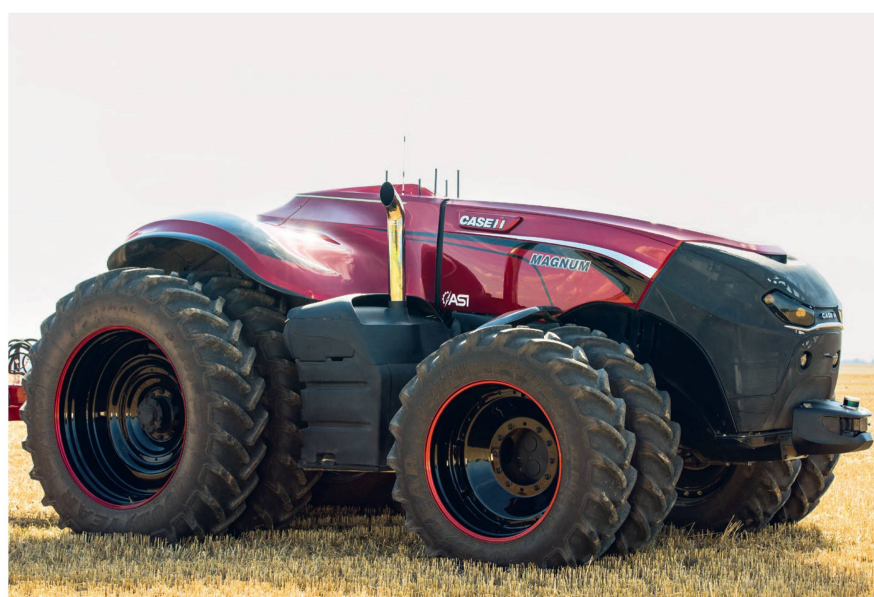
Grâce à un radar, un lidar et des caméras vidéo à bord, ce « Magnum » de Case IH détecte les obstacles fixes et mobiles sur son chemin et s'arrête automatiquement. Des tâches préprogrammées peuvent être effectuées au moyen de l'interface de commande à distance. Photo : Case IH
