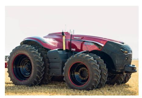
Grâce à un radar, un lidar et des caméras vidéo à bord, ce «Magnum» de Case IH détecte les obstacles fixes et mobiles sur son chemin et s'arrête automatiquement. Des tâches préprogrammées peuvent être effectuées au moyen de l'interface de commande à distance. Photo: Case IH
