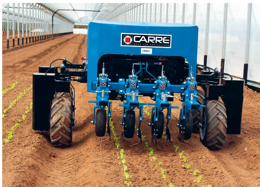
Le robot de sarclage « Anatis » de Carré est piloté par caméra et par GPS. Il fonctionne avec une batterie au lithium qui offre huit à dix heures d'autonomie et qui se recharge en trois heures. Photo : Carré
