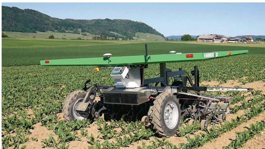
En Suisse orientale et occidentale, on a recouru au printemps 2020 à un robot Farmdroid « FD 20 » pour le semis et le hersage (en plusieurs passages) d'une poignée de champs de betteraves sucrières. Photo : Roman Engeler
