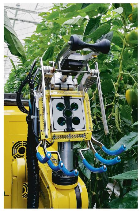
Le robot «Sweeper» est capable de cueillir les poivrons de manière autonome dans les serres grâce à une caméra 3D. Son «taux de réussite» avoisine actuellement les 62%. Photo: Idd
