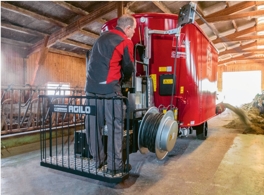
L'«Agilo 2-S» de Kurmann permet d'entraîner des mélangeuses BvL à double vis à l'électricité. Photo: Roman Engeler
