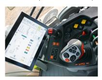
un système interactif et « autodidacte » d'assistance à la conduite et d'optimisation des machines que Claas propose en option sur certains tracteurs « Arion » et « Axion ».
