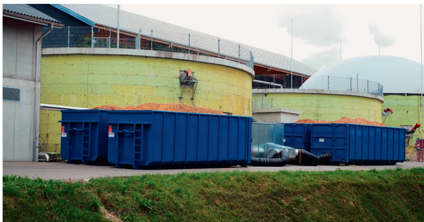
Séchage de bois en conteneurs utilisant la chaleur résiduelle de l'installation de méthanisation à l'arrière-plan.
