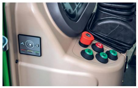
Il est nécessaire de disposer d'arrêts d'urgence à la fois dans la cabine du tracteur et sur la machine.
