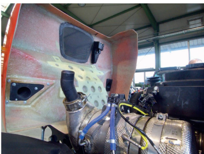
Le moteur, ici avec capot ouvert, est monté à l'arrière, les gaz d'échappement sont évacués vers le haut, bénéficiant d'un effet Venturi.
