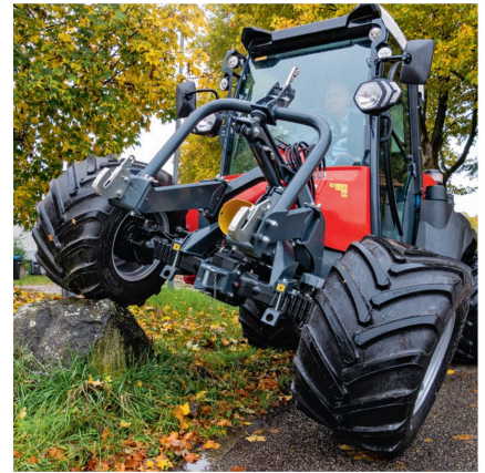
L'essieu avant oscillant permet un débattement de 17 degrés.
