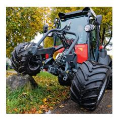
L'essieu avant oscillant permet un débattement de 17 degrés.
