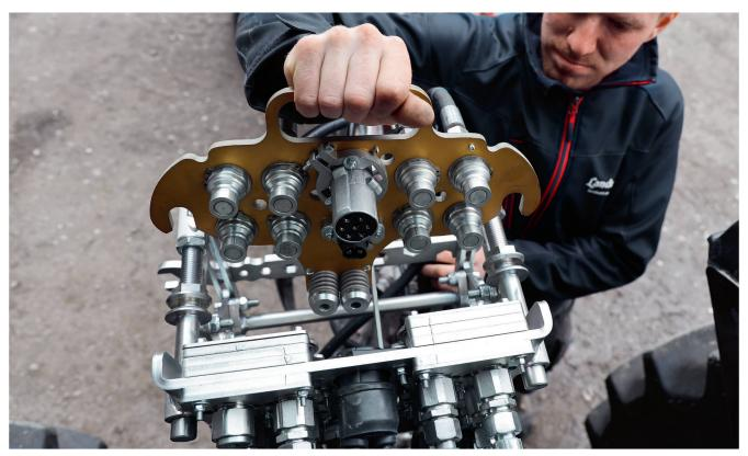
Le «F-Con Multi» permet de brancher en une seule opération jusqu'à huit conduites hydrauliques, deux liaisons électriques et la conduite de frein pneumatique. Photos: Johannes Paar
