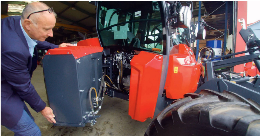
Le radiateur complet est pivotant: ce qui donne un accès au moteur sans avoir besoin d'outil.
