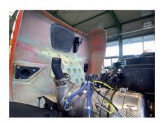
Le moteur, ici avec capot ouvert, est monté à l'arrière, les gaz d'échappement sont évacués vers le haut, bénéficiant d'un effet Venturi.
