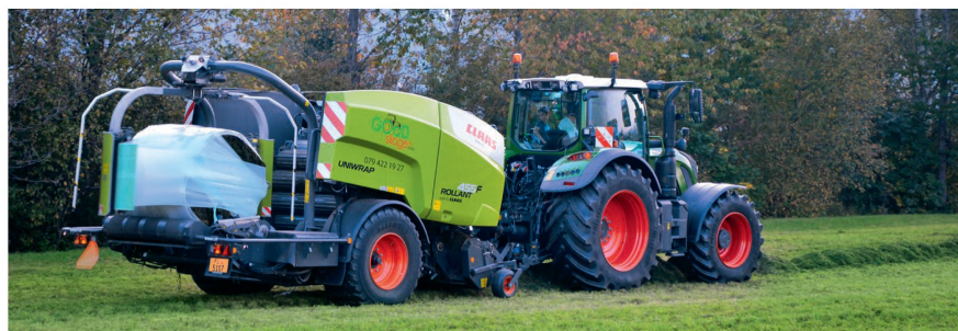
Le tracteur peut également être commandé par l'outil attelé grâce au système TIM (ou tractor implement management).
