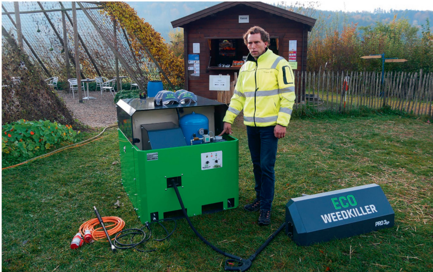
Hanspeter Bleuler: « Avant l'utilisation, les 300 litres d'eau du réservoir sont chauffés électriquement à une température de 100 degrés. Le tuyau sur enrouleur intégré mesure 18 mètres. » Photos: Heinz Röthlisberger et Idd
