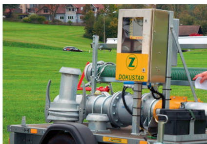
Lors du transfert de lisier, la station mobile «Dokustar» mesure le volume et la composition de l'amendement.
