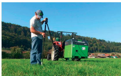
Le désherbeur à eau bouillante peut aussi combattre les adventices plant par plant.
