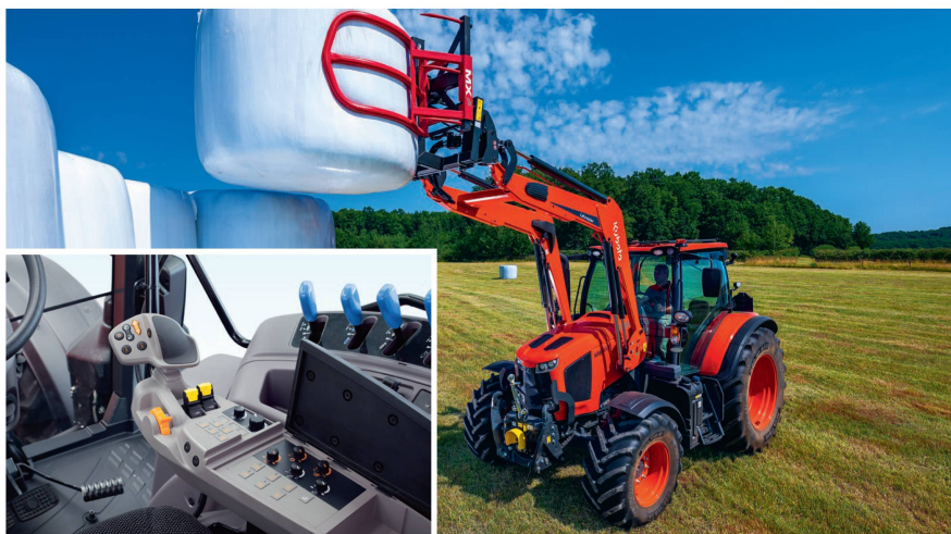
Les trois modèles de la gamme «M6002» ont des puissances allant de 123 à 143 chevaux. Toutes les commandes de l'accoudoir multifonctions sont à portée de main. Photos: Kubota
