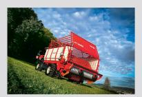
tion. La porte arrière s'ouvre et se bascule hydrauliquement de la cabine. C'est désormais un équipement de série. Le dispositif de déchargement rapide se met automatiquement en place lorsque la porte arrière est relevée. Les autochargeuses «LD 530» et «LD 540» sont disponibles pour les empattements court et long, ainsi qu'en versions étroite et large.
