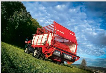
La porte arrière s'ouvre et se bascule hydrauliquement de la cabine. C'est désormais un équipement de série. Le dispositif de déchargement rapide se met automatiquement en place lorsque la porte arrière est relevée. Les autochargeuses « LD 530 » et « LD 540 » sont disponibles pour les empattements court et long, ainsi qu'en versions étroite et large.
