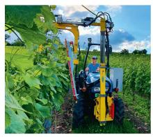
La releveuse-palisseuse. Les agraphes sont placées en appuyant sur un bouton.
