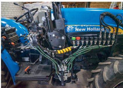
Bloc hydraulique installé par Dominik Gasser pour alimenter les outils sur le mât frontal.
