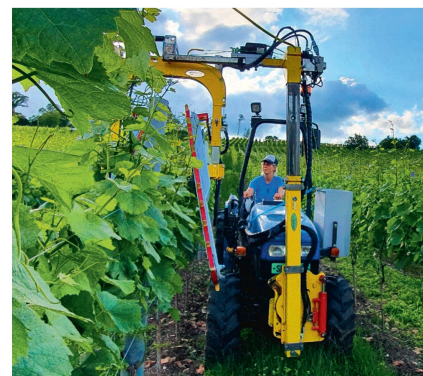
La releveuse-palisseuse. Les agraphe sont placées en appuyant sur un bouton.
