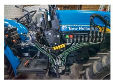
Bloc hydraulique installé par Dominik Gasser pour alimenter les outils sur le mât frontal.
