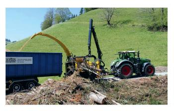
Les broyeurs Wüst «BBHK» peuvent être entraînés directement ou par prise de force. Photo: Wüst
