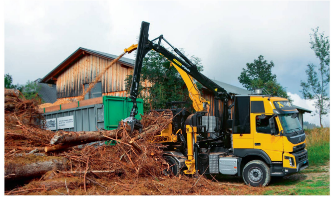
Le dernier-né de Wüst est le «SMC-812» avec entraînement direct par le moteur du camion. Le broyeur est commandé depuis la cabine.
