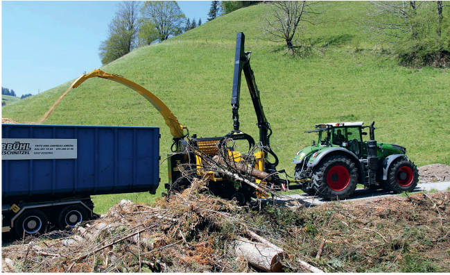
Les broyeurs Wüst «BBHK» peuvent être entraînés directement ou par prise de force. Photo: Wüst
