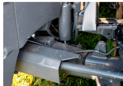
Le confort de conduite est amélioré notablement avec la cabine et le pont avant suspendus disponibles en option.
