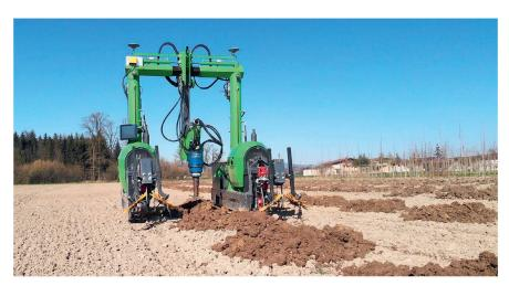
La tarrière montée sur le relevage central peut forer des trous de 50 à 100 cm de diamètre, de manière totalement automatique.
