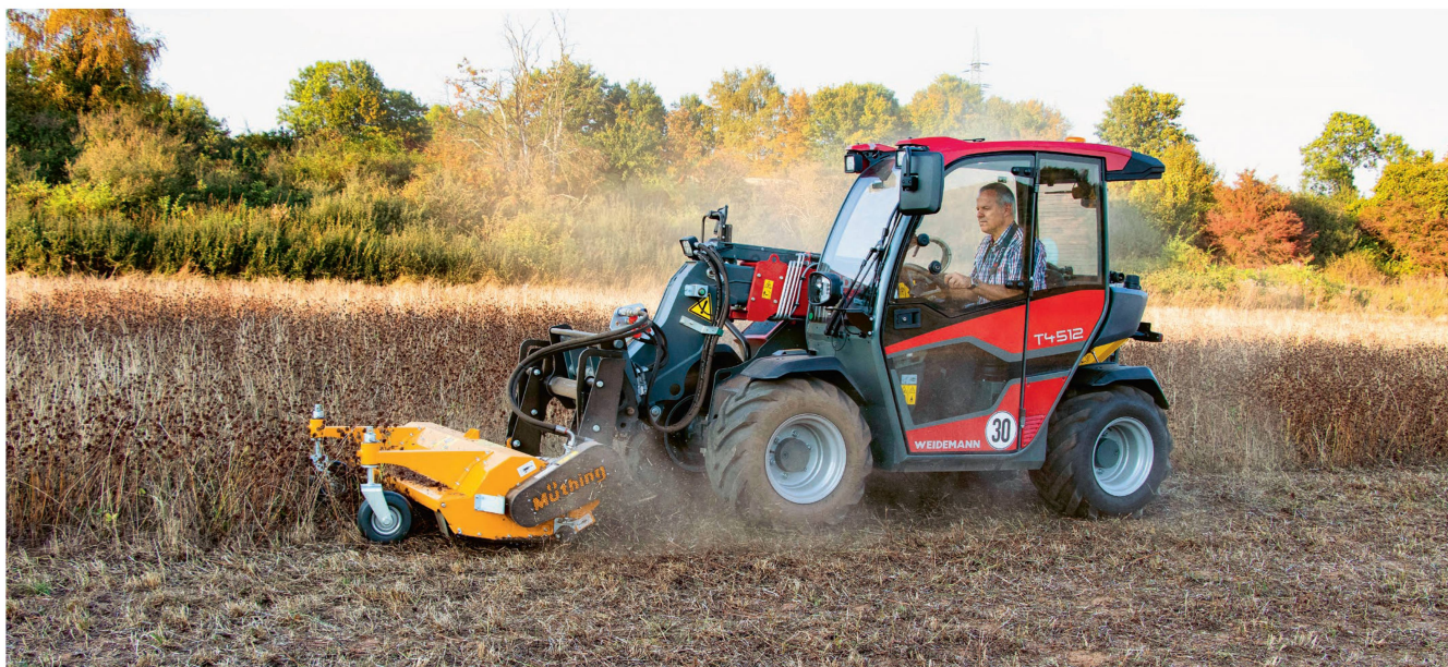
Le « T4512 » dans la version avec la motorisation la plus puissante. Il est ici équipé d'un broyeur à entraînement hydraulique et roule en mode « Équipement ». Photos : D. Gischen
