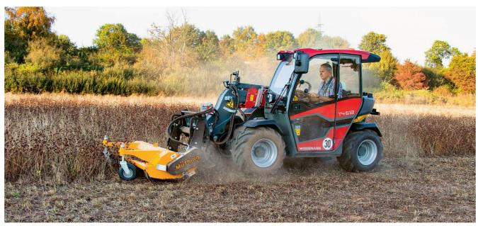
Le «T4512» dans la version avec la motorisation la plus puissante. Il est ici équipé d'un broyeur à entraînement hydraulique et roule en mode «Equipement». Photos: D. Gischen
