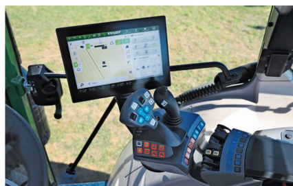
Le nouvel accoudoir avec ses commandes fait partie des éléments constitutifs du «FendtOne», avec le levier multifonctions modifié et l'écran optionnel.
