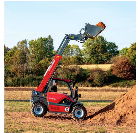
Les système d'assistance au pilotage « VLS » améliore la stabilité de la machine.
