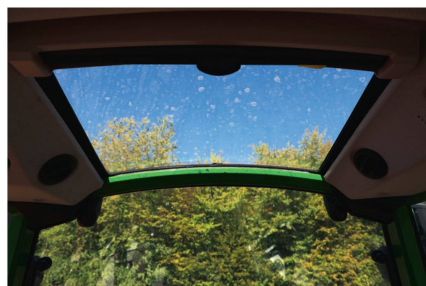
La cabine transformée avec le pare-brise plus haut et l'entretoise plus fine qui le sépare de la lucarne de toit.
