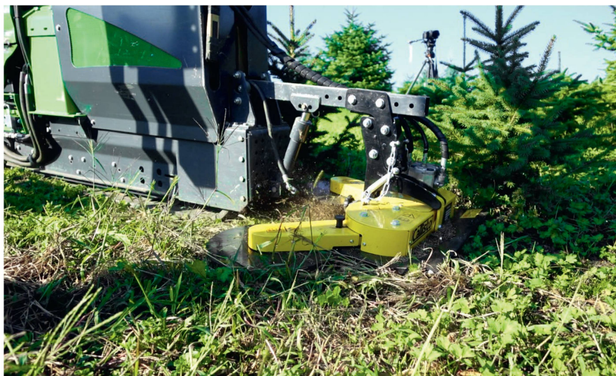
On peut, par exemple, monter jusqu'à trois broyeurs sur le porte-outils pour des interventions dans des sapins de Noël, comme ici.
