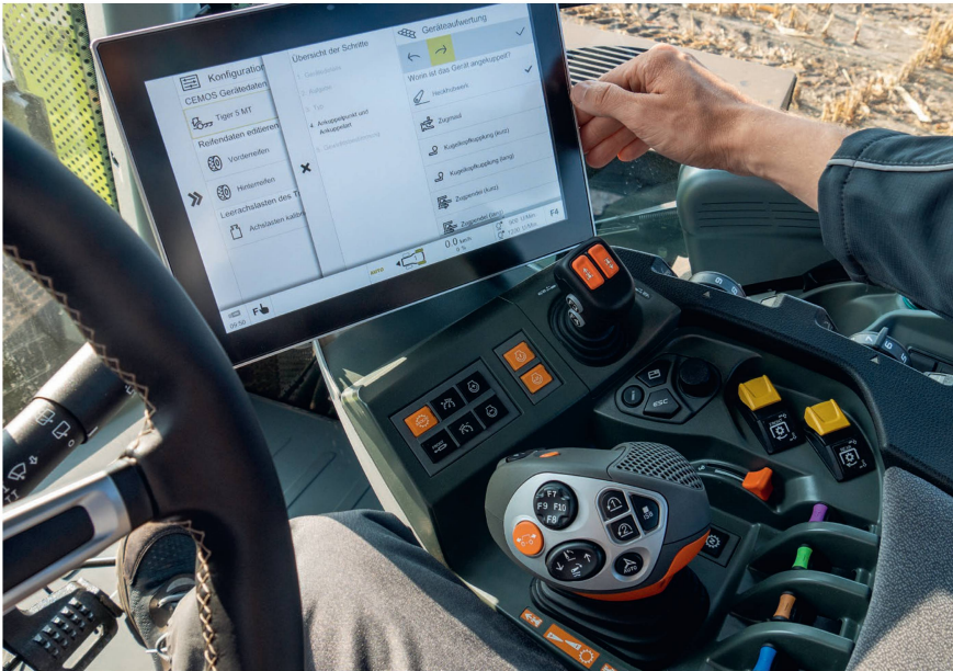
C'est le nouveau cerveau du tracteur: le système «Cemos» intègre un assistant de conduite, un système d'optimisation du fonctionnement du véhicule qui doit alléger la tâche du conducteur et lui permettre d'exploiter tout le potentiel de son engin.
