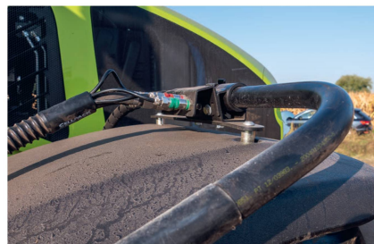
Pour circuler sur la voie publique, les tuyaux de l'installation de télégonflage peuvent être ramenés sur le dessus des gardes-boues.
