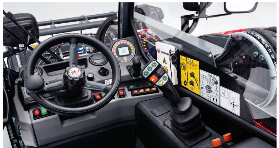
Les commandes sont ordonnées selon un système de couleurs. Le joystick a été complètement revu. Photo : Weidemann
