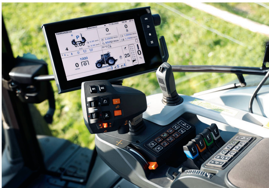
À l'instar des gros tracteurs Valtra, les modèles «Versu» de la gamme «G» sont dotés de série de la commande «SmartTouch».
