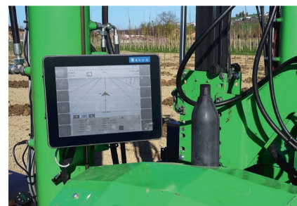
Le porte-outils reçoit les ordres par un écran tactile ou une radiocommande.
