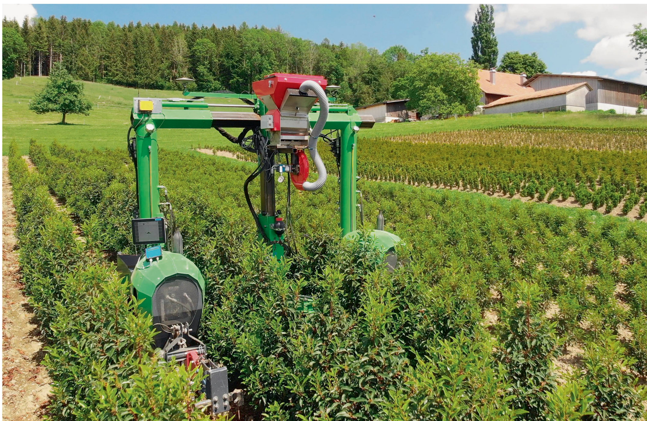
Le porte-outils «Flunick» exécute de multiples opérations de manière entièrement autonome. Il est ainsi capable de sarcler simultanément trois interrangs en un seul passage. Photos: Ruedi Burkhalter
