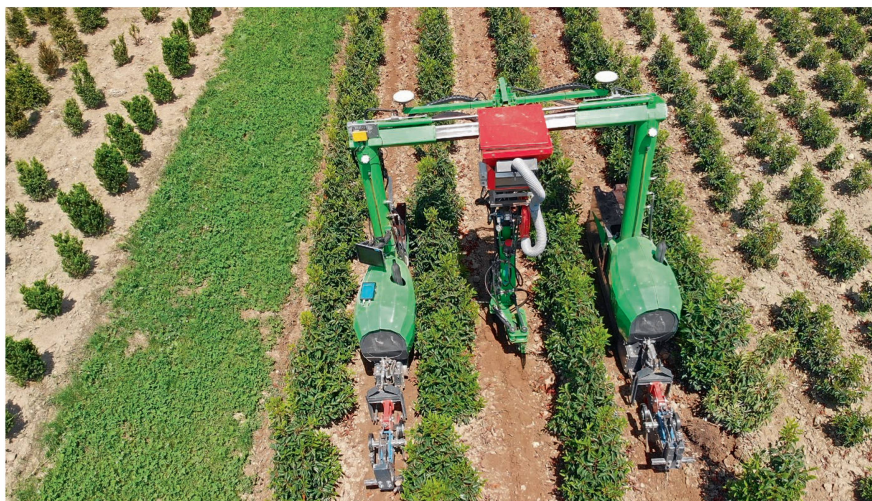
Le désherbage mécanique de précision permet de limiter l'usage d'herbicide, voire d'y renoncer.
