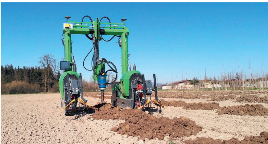
La tarrière montée sur le relevage central peut forer des trous de 50 à 100 cm de diamètre, de manière totalement automatique.
