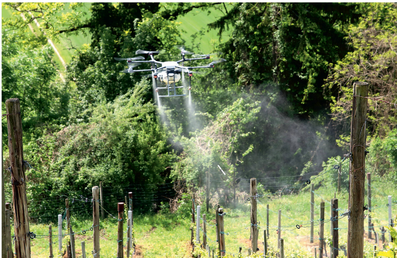
Les drones peuvent réellement remplacer les pulvérisateurs, en particulier dans les parcelles pentues. Photo : Landi Weinland
