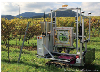
Le robot de phénotypage est principalement conçu pour la culture de la vigne. Photo : JKI
