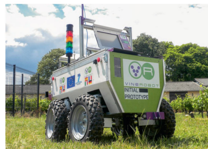
Le « VineRobot » enregistre notamment la composition des raisins. Photo : ldd
