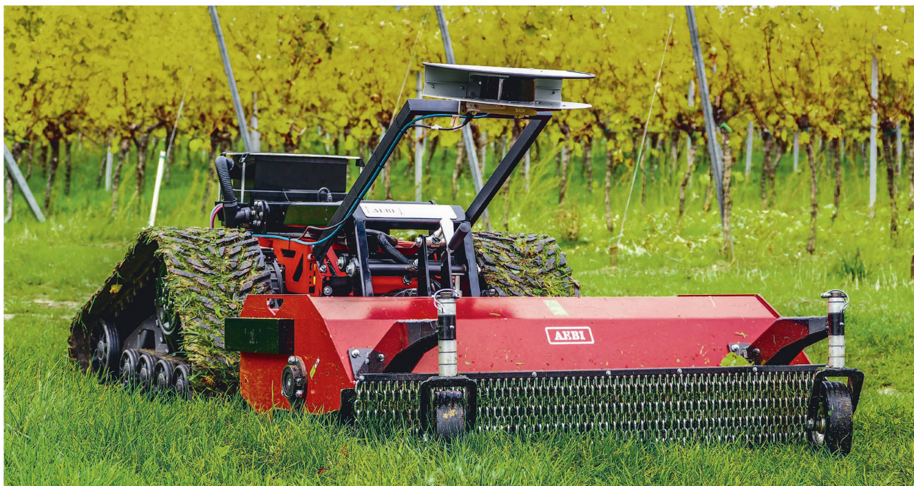
Dotés d'un «kit autonomie» pour les cultures en lignes, des porte-outils adaptés peuvent être automatisés. Photo: Robot Markers
