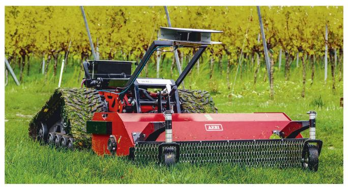
Dotés d'un «kit autonomie» pour les cultures en lignes, des porte-outils adaptés peuvent être automatisés. Photo: Robot Markers
