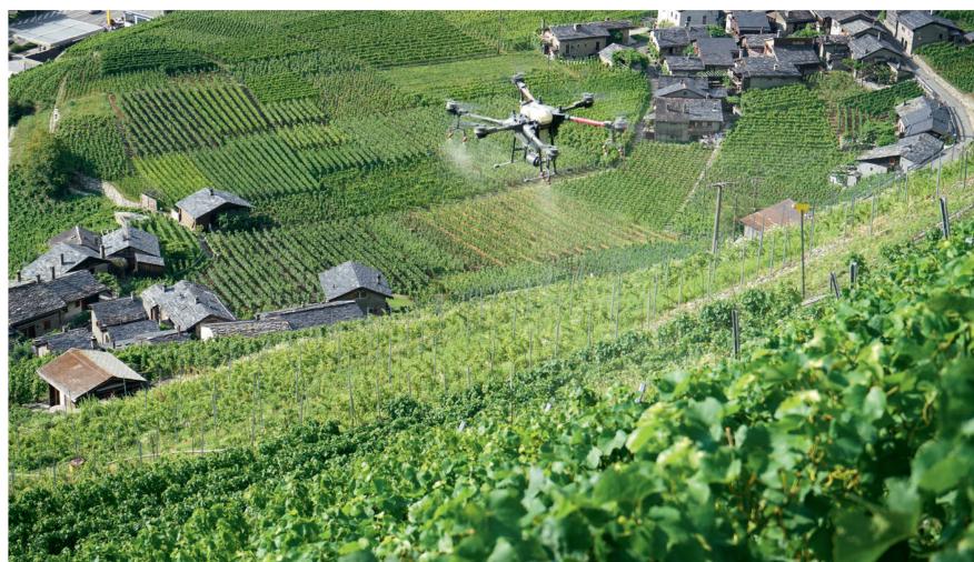
Équipé d'une cuve d'une capacité de 16 litres, le drone des Besse est capable de traiter plus de 1000 mètres carrés en quatre minutes.
