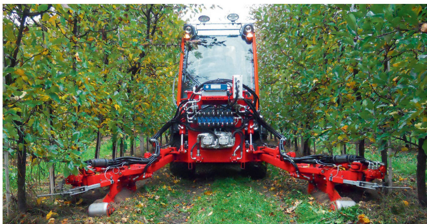
Les équipements permettant d'entretenir les rangs d'arbres sans herbicide existent, mais ils ont un coût. Photo : Ladurner
