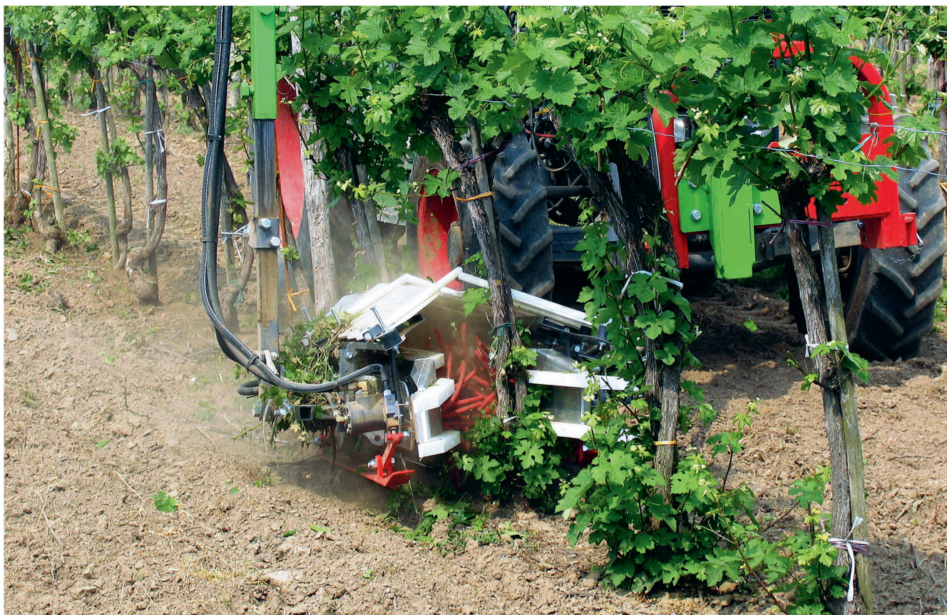
En principe il est possible de pratiquer le désherbage mécanique pour éliminer les adventices sur le rang, comme ici dans une vigne. Photo: Hammerschmied GmbH
