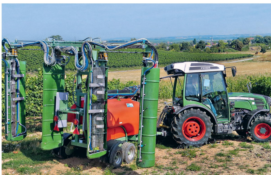
Pulvérisateur tangential performant pour les grands vignobles faciles d'accès. Photo : ldd
