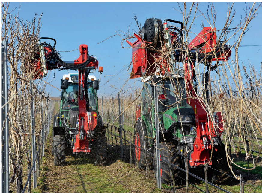
Les épareuses et les rogneuses-écimeuses facilitent le travail manuel, mais ne le remplacent.
