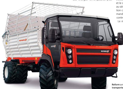
Reform a retravaillé le milieu de gamme de ses transporters «Muli» de 109 chevaux et les a dotés d'une cabine totalement nouvelle. Photo: Reform
