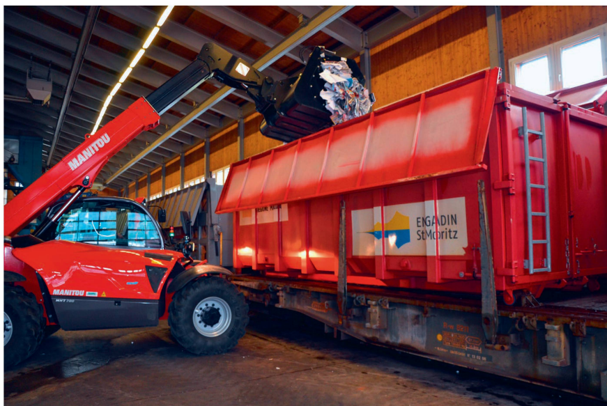
Les conteneurs placés sur les wagons peuvent être remplis facilement grâce au bras télescopique et au col de cygne.
