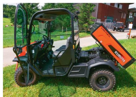
Le Kubota «RTV X1110» est muni d'une benne basculante hydraulique et d'un relevage avant. La cabine fermée offre un poste de travail agréable.
