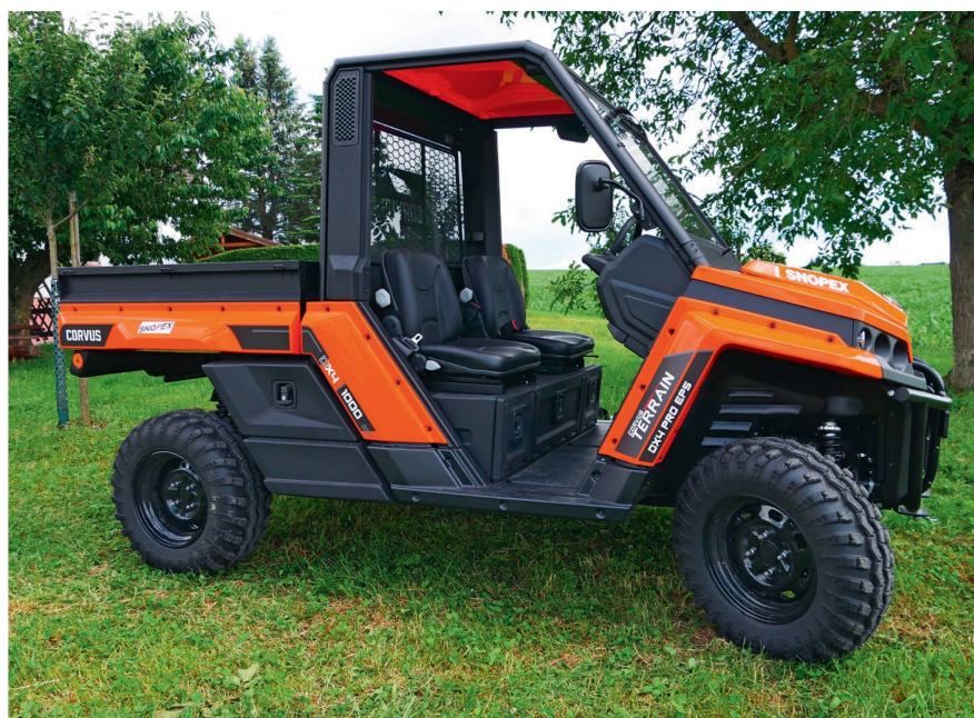
Le Corvus «Terrain DX4 Pro» dispose de nombreux et de larges espaces de rangement malgré une cabine simple. Le pont de chargement est inclinable manuellement.
