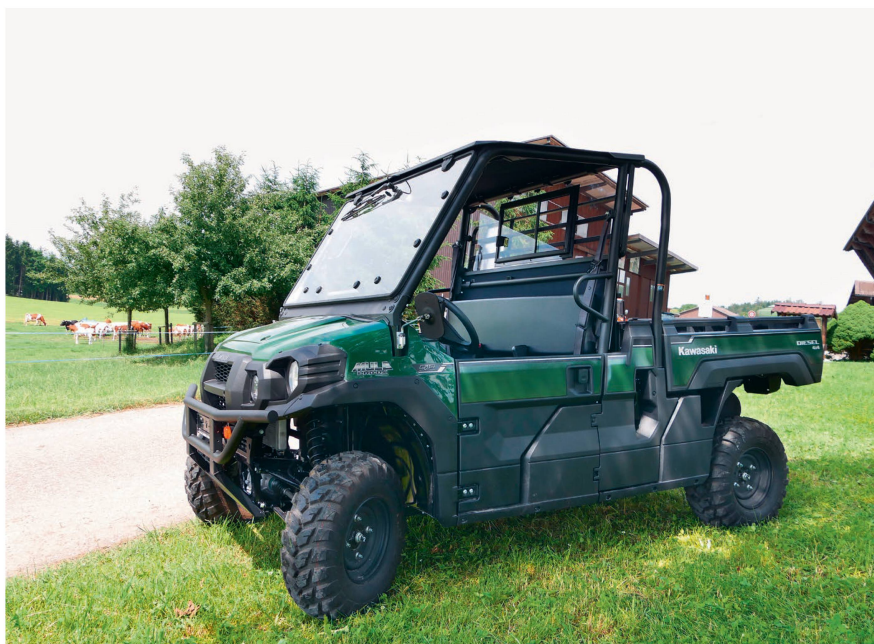
Le Kawasaki «Mule Pro DX» est pourvu d'une banquette d'un seul tenant. La benne basculant manuellement est très spacieuse.
