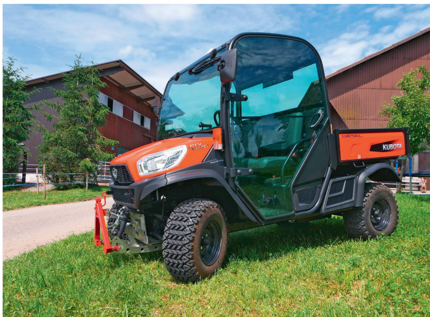
Le Kubota «RTV X1110» est muni d'une benne basculante hydraulique et d'un relevage avant. La cabine fermée offre un poste de travail agréable.
