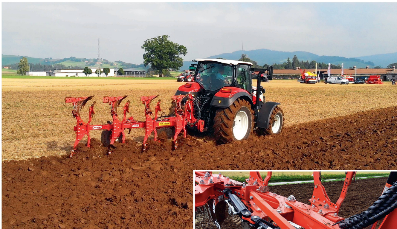
Le centre de réglage de l'«Unico» fonctionne sur la base de deux parallélogrammes en série. Photos: Ruedi Burkhalter
