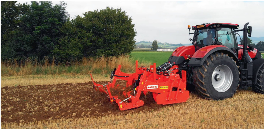
Le décompacteur-déchaumeur « Attila » travaille simultanément sur deux niveaux.
