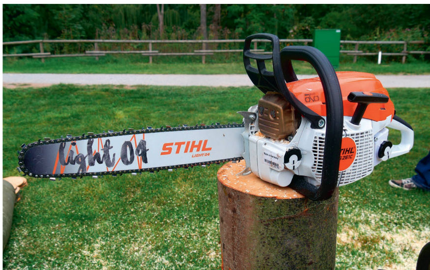
La tronçonneuse Stihl «MS 261 C-M» est équipée d'un moteur de 50 cm 3 , de la nouvelle chaîne «325" Pro» et du guide-chaîne inédit «Light 04». Photos: Heinz Röthlisberger
