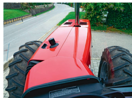
Le « nez » du tracteur se prolonge de trois mètres vers l'avant à partir de l'articulation.
