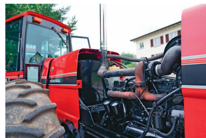
L'accès au moteur se dégage complètement grâce au capot « roll-back ».
