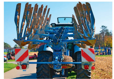
L'éclairage du tracteur est masqué par cette charrue qui doit impérativement être munie de panneaux de signalisation, d'un éclairage et de catadioptres ronds. Photo : Ruedi Hunger
