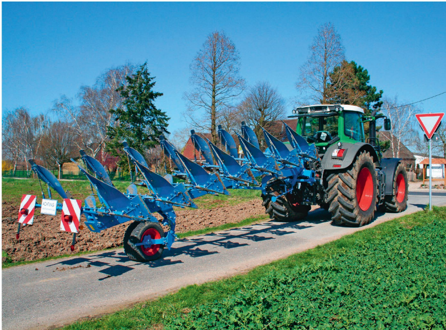
Cette charrue est une «remorque de travail». Peu importe qu'elle soit transportée droite ou couchée, des panneaux de signalisation, un éclairage et un triangle réfléchissant sont indispensables. En outre, des panneaux de signalisation latéraux seraient souhaitables.
