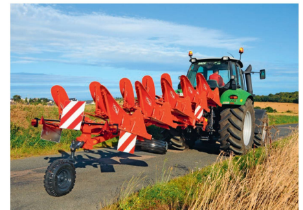
Afin d'améliorer la sécurité, cette charrue est équipée de panneaux de signalisation latéraux. Photo : Kuhn
