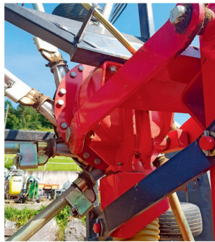
La suspension des toupies par cardan en position de transport.
