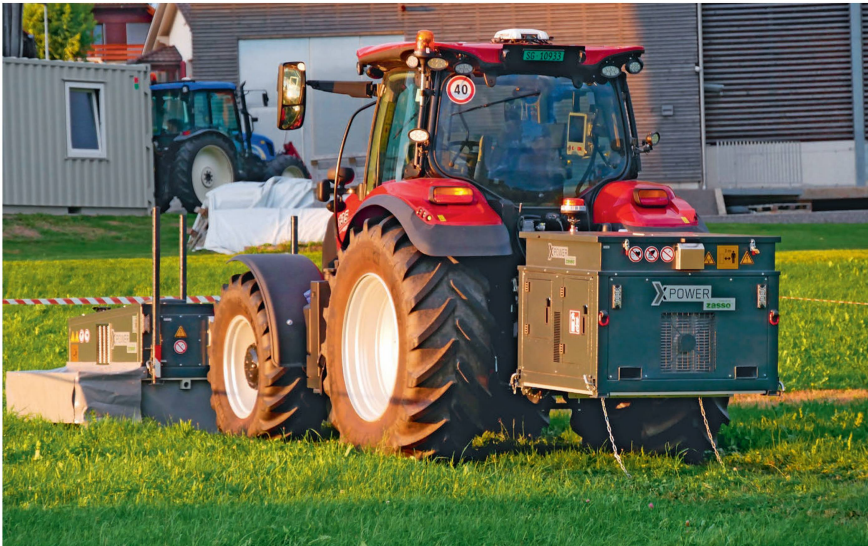
Le générateur situé à l'arrière produit le courant grâce à la prise de force. Une distance de sécurité doit être respectée pendant et après l'utilisation.
