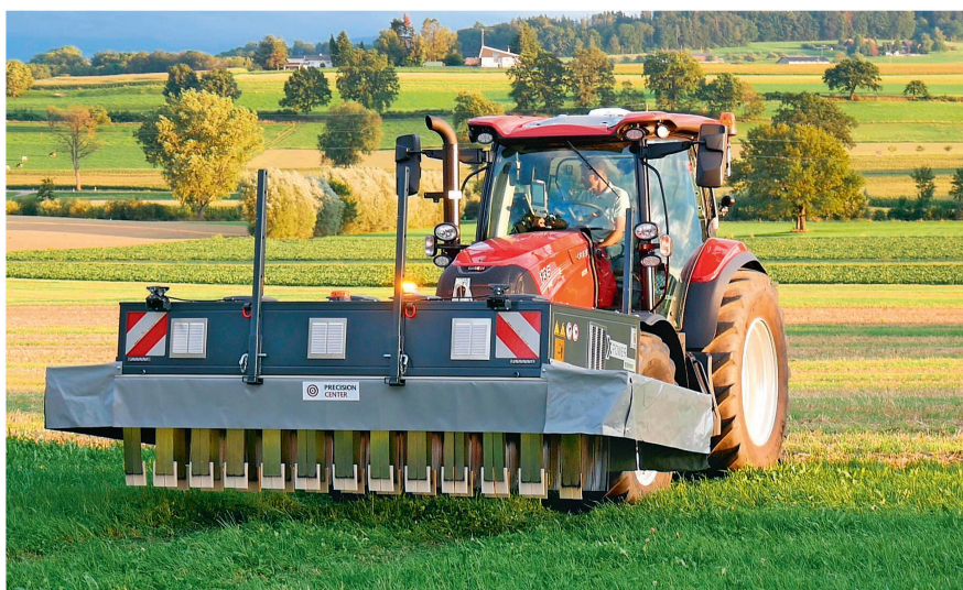
Le «XPower Electroherb» en action: le courant circule dans les plantes au travers des applicateurs. Photos: Heinz Röthlisberger
