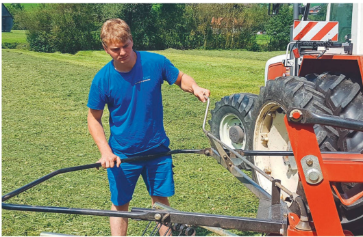
Une manivelle permet de régler la hauteur de travail des toupies.
