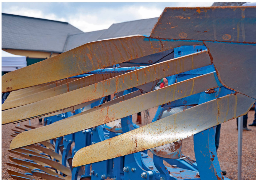
Les aciers de haute qualité permettent de réduire l'usure de près de 60%, et de prolonger la durée de vie des pièces d'usure d'un facteur de 2,5. Photo: Ruedi Hunger
