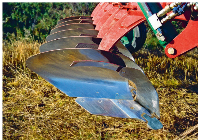
La Kverneland Ecomat offre une combinaison originale de socs et de déflecteurs d'incorporation de paille. Photo: Kverneland
