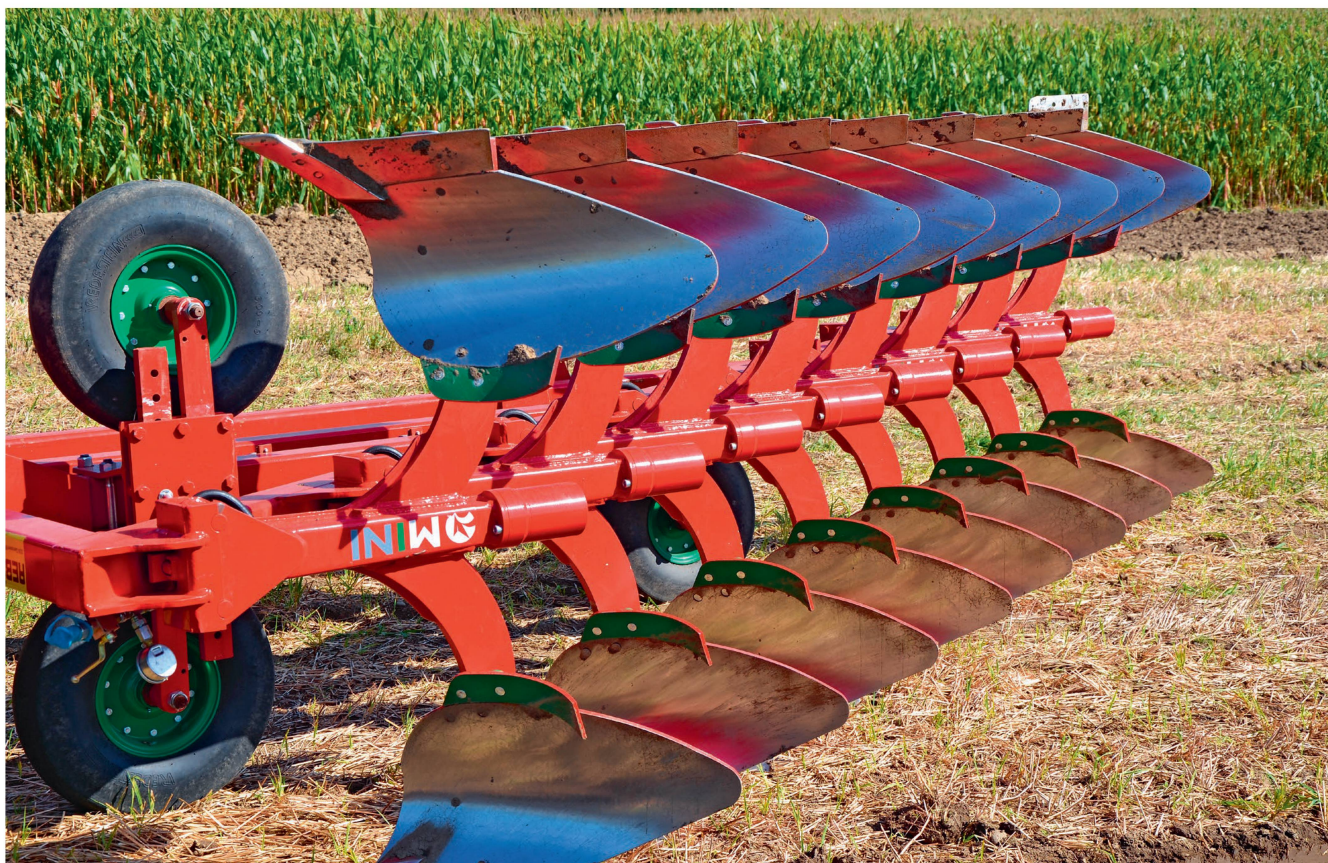
Un processus de travail superficiel précis nécessite souvent un châssis à deux roues, à l'exemple de cet Ovlac Mini. Photo : Ruedi Hunger
