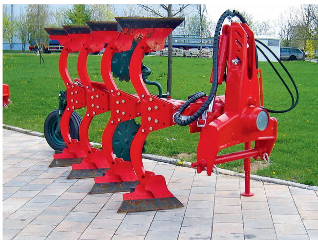
Le « Stoppelhobel » se distingue des autres charrues déchaumeuses par ses outils de rabotage. Photo : Zobel
