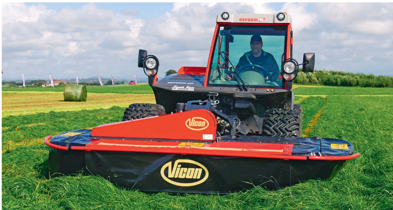
Avec le modèle « Extra 324 F Alpin », Vicon propose dans son assortiment une faucheuse à disques frontale, légère et compacte, qu'il a conçue pour les zones de montagnes. Photos : Roman Engeler
