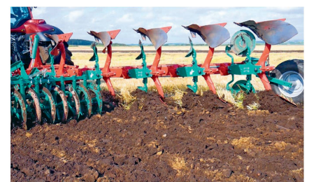
Même sur la charrue, des détails peuvent être perfectionnés, telle ici la nouvelle forme de l'étauçon avec l'«Aero-Profil».
