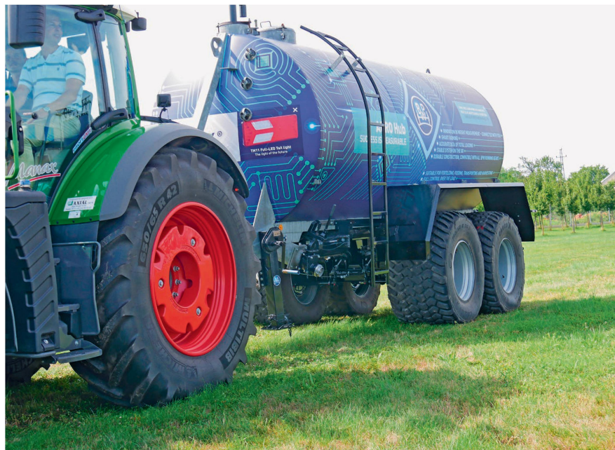
Un système de pesage numérique BPW est installé sur ce châssis. Photos : Roman Engeler
