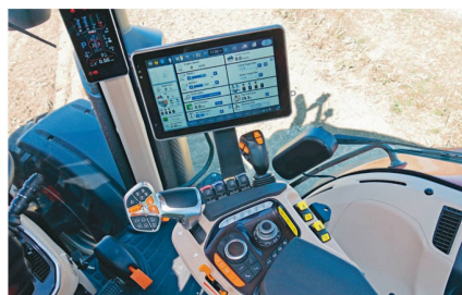
Les deux écrans doivent simplifier et améliorer la conduite. Le « Multicontroller » (à gauche) possède maintenant quatre touches programmables.
