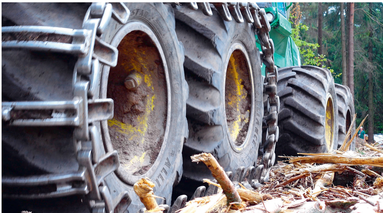
Grâce à sa technologie basse pression, le pneu « 344 Elit » laisse moins de traces en forêt. Photos : Ruedi Burkhalter
