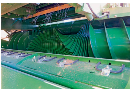
Le rotor de coupe intégral équipé de vis sans fin est l'une des nouveautés des modèles « VariPack ».
