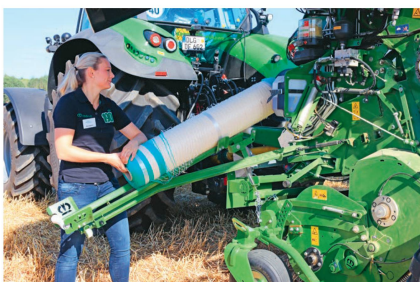
Le rotor de coupe intégral équipé de vis sans fin est l'une des nouveautés des modèles « VariPack ».
