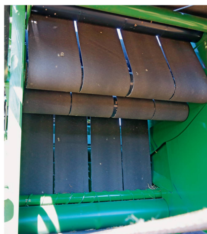
Les quatre courroies plates peuvent être libérées en actionnant un levier lorsque la chambre de pressage est ouverte.
