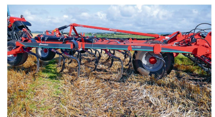
Le «Turbo T i-Tiller», un cultivateur «intelligent», commandé via un système Isobus complète la série d'outils de travail du sol.
