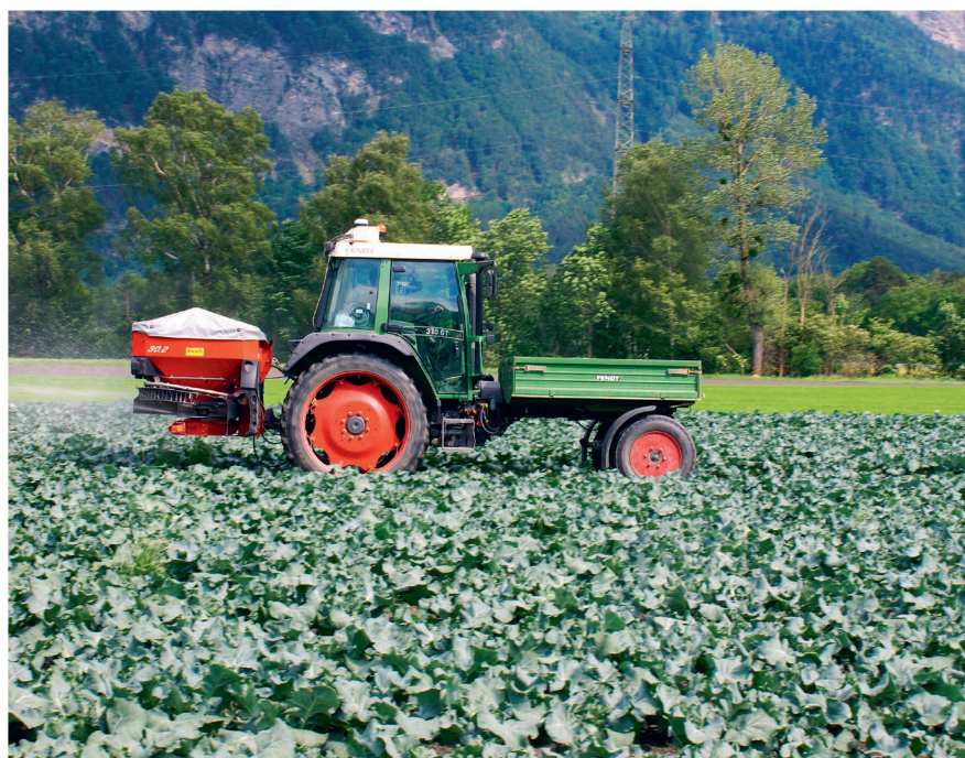
Une tonne au trois-points ne lui fait pas peur; il la supporte sans contrepoids frontal.
