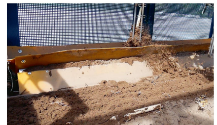
L'organe perforateur de gauche dépose une asperge sur le convoyeur.
