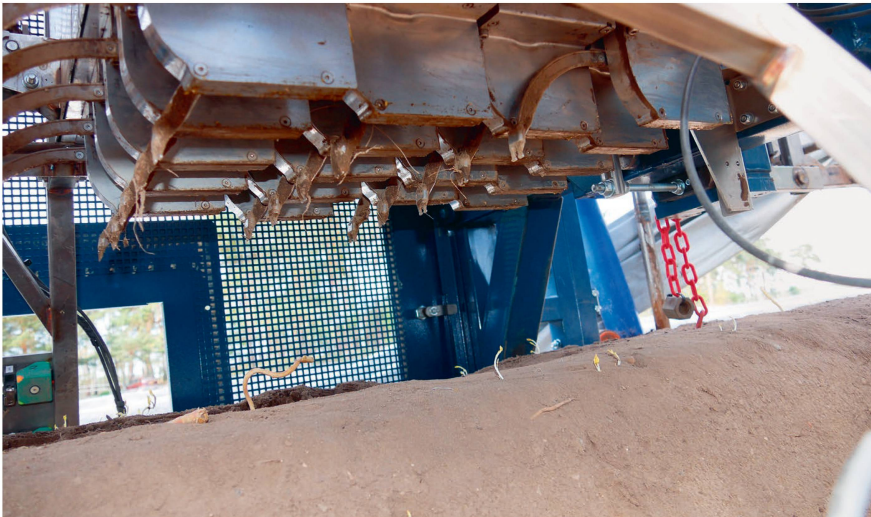
Vue de l'«organe de détection»: les tiges sont équipés de capteurs qui localisent les asperges dans le sol. Elles se relèvent (comme sur la photo) juste avant d'entrer en contact avec les pousses.
