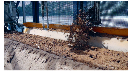
« Organes perforants »: ils sont deux par rangée qui prélèvent les asperges avec un peu de terre, les secouent et les déposent sur un tapis roulant. On distingue dans l'organe de droite une asperge débarrassée de la terre.
