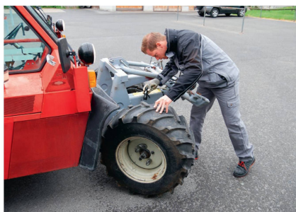
On voit sur cette photo le contrôle de l'état des essieux et de la direction.
