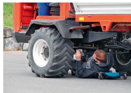
Le système de freinage et l'usure des conduits font également partie du contrôle.
