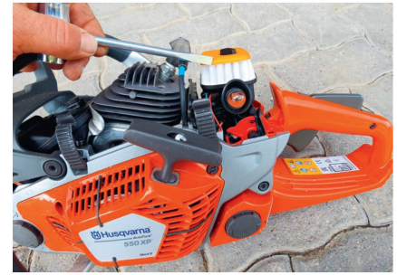
Grâce au dispositif de fermeture rapide, le filtre à air peut se changer sans outil.
