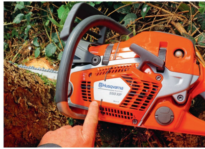
Le marquage de positionnement permet une plus grande précision lors de l'abattage.
