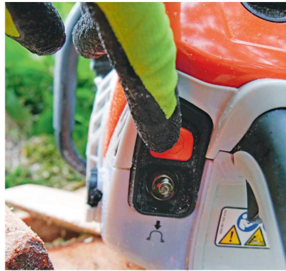
Le levier «start/stop/choke» a été remplacé par un seul bouton d'arrêt avec purgeur au-dessous.
