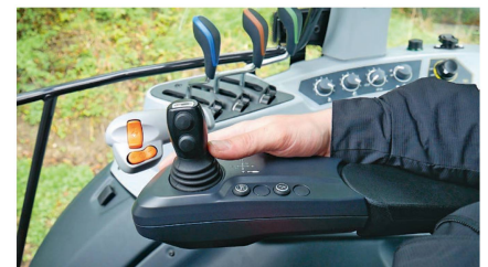
Le levier en croix dispose d'une commande électrique, ainsi que d'une troisième et quatrième fonctions optionnelles pour le chargeur frontal. A l'arrière, l'interrupteur à bascule sert à activer la boîte à vitesses.
