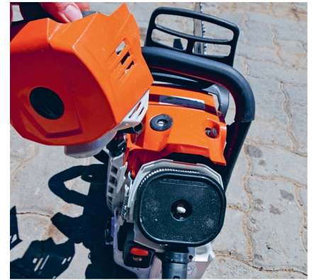
Le couvercle du filtre se démonte rapidement et sans outil, ce qui facilite le nettoyage.
