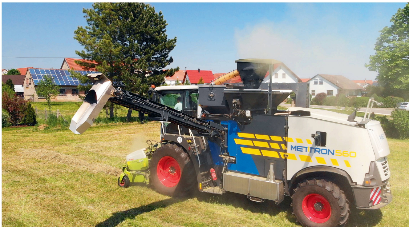
La trémie-tampon et la trémie à pellets sont montées au milieu, au-dessus de l'unité de granulation. Photos: Ruedi Burkhalter
