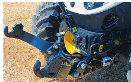
Le relevage électronique avant dispose de fonctions bien pratiques. Il est intégré au bloc essieu.
