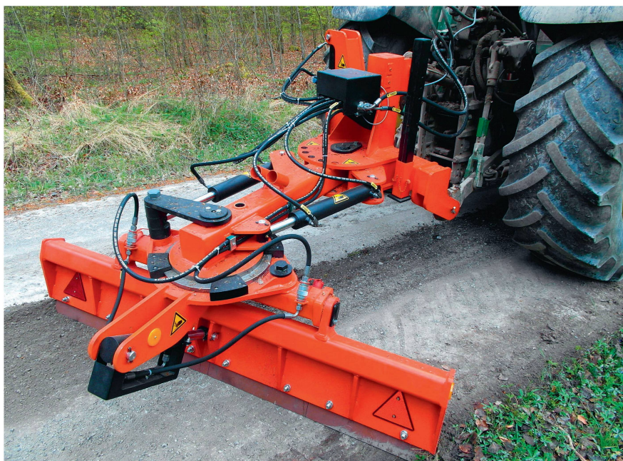
La lame niveleuse est un outil utile pour l'entretien annuel. Photo: KWF
