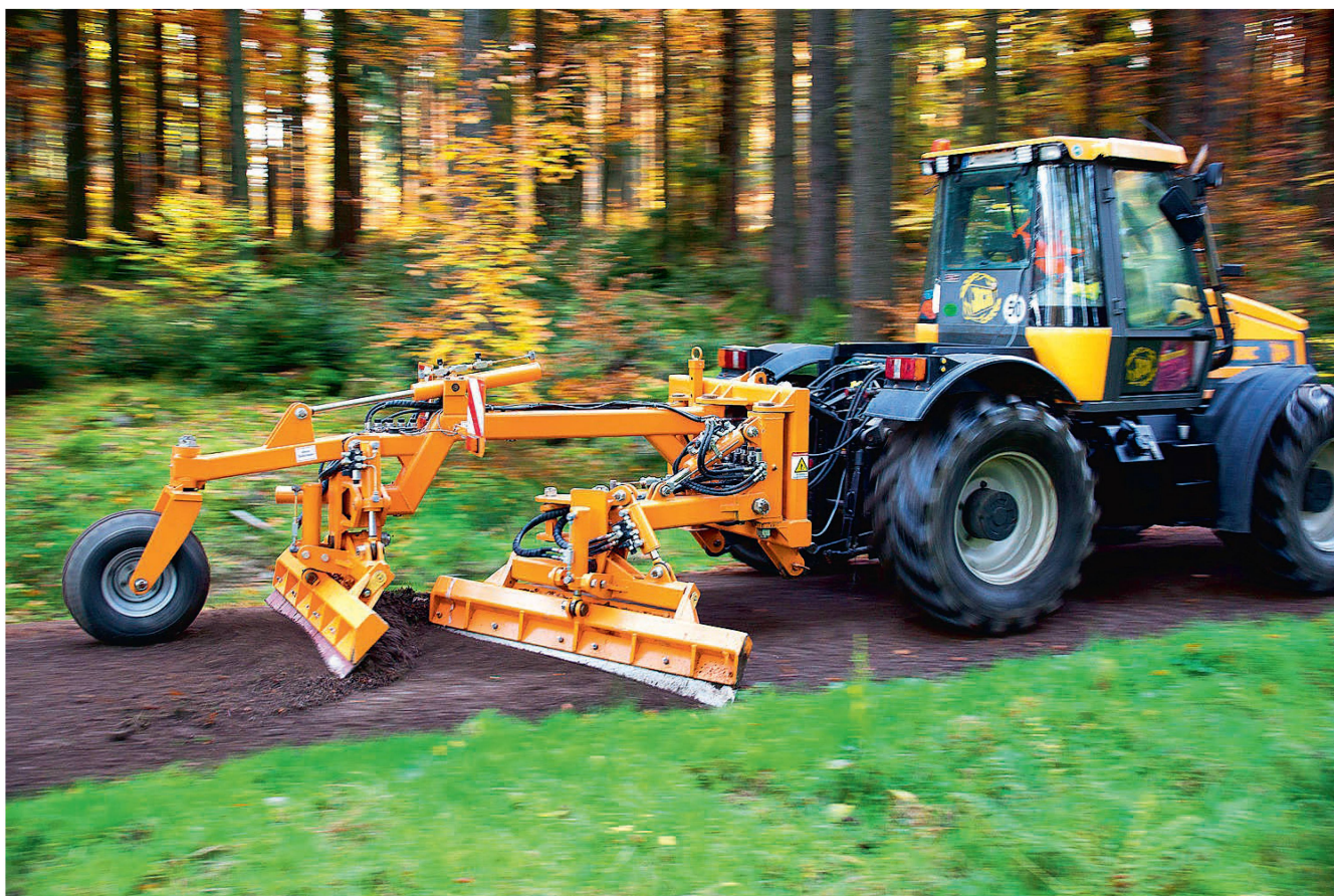
L'outil combiné «R 2017» utilise le matériel disponible pour créer une nouvelle couche d'usure. Photo: KWF
