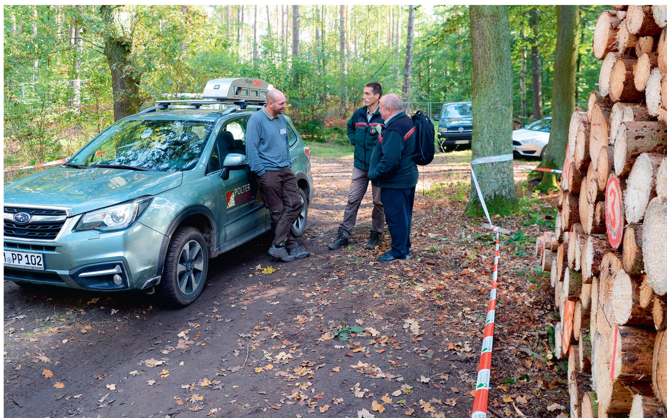
Cubage de bois à l'aide de caméras embarquées sur le toit d'un véhicule. Des logiciels permettent le traitement des images de manière quasi instantanée. Photo : kwf
