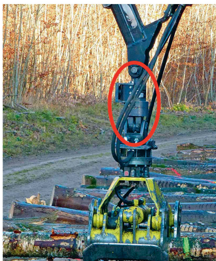
La balance intégrée au bras de la grue est un instrument efficace pour peser les bois de feu et d'énergie. Photo : fva
