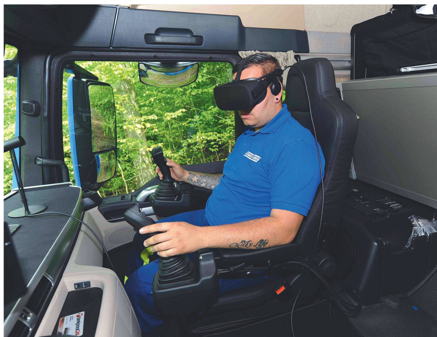
« Je vois ce que tu ne vois pas ! » La grue est commandée en réalité virtuelle depuis la cabine.
