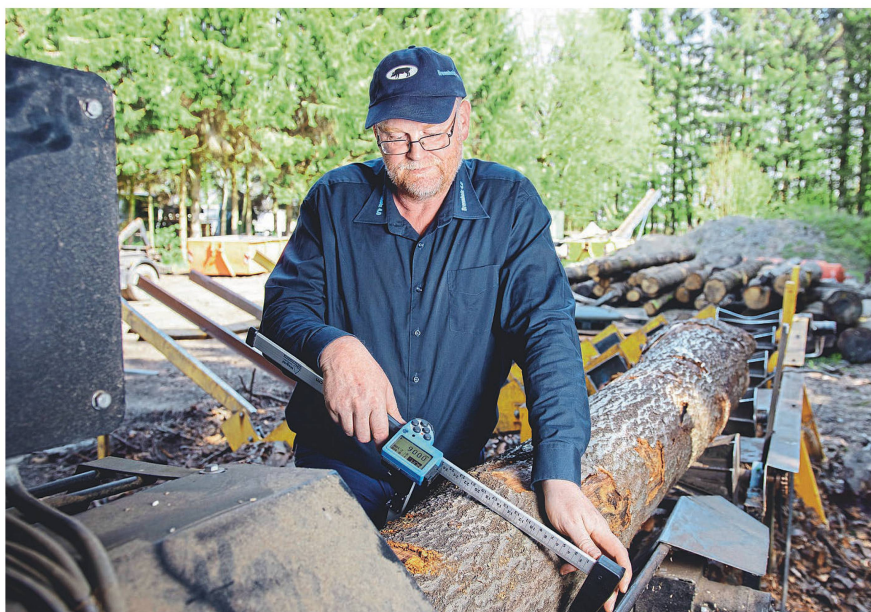
Les données de mesure du compas forestier électronique sont enregistrées et remises au client. Photo : Meiners
