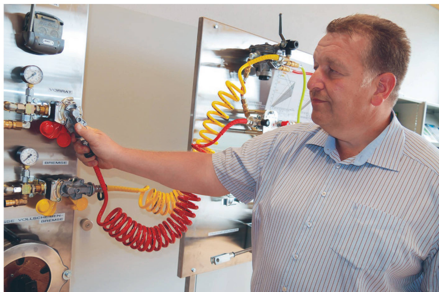
Roger Stirnimann devant le modèle d'une installation de freinage pneumatique. La conduite à raccord rouge assure une alimentation en énergie permanente, l'actionnement des freins s'effectue par la conduite jaune.
