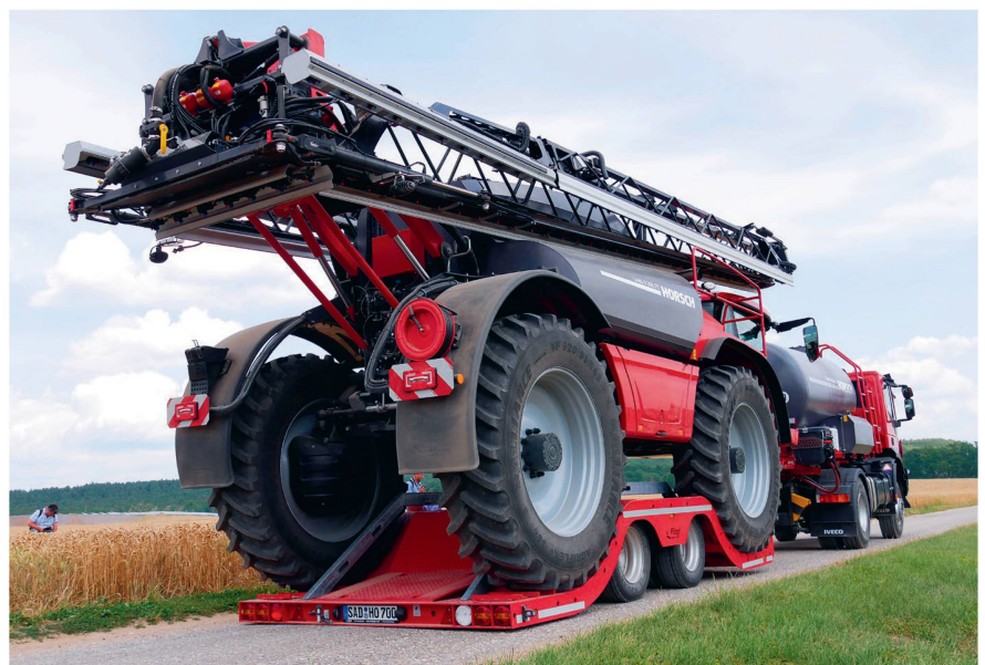
Dispositif d'approvisionnement et de transport pour le pulvérisateur automoteur de type « Leeb 8.300 PT », destiné à devenir autonome à l'avenir.
