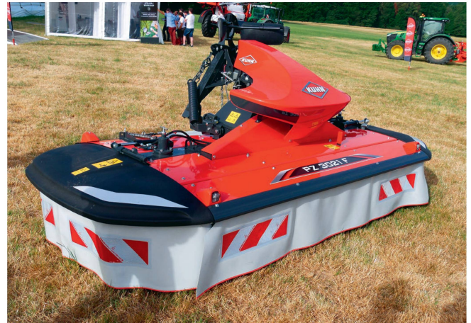
Les faucheuses frontales à tambours «PZ 3021 F» et «PZ 2721 F» sont désormais équipées de patins à rotation libre.
