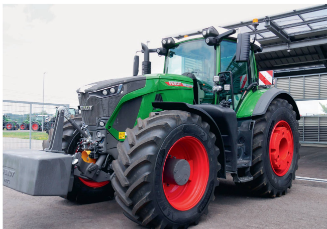
Le modèle «942» élargit vers le haut la gamme «900 Vario» de Fendt, qui franchit ainsi la barre des 400 chevaux. Il sera muni de la transmission «Vario Drive», héritée de la série «1000 Vario».
