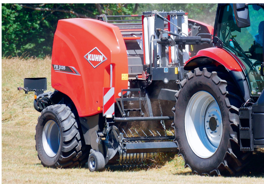
Kuhn équipe désormais également la presse à balles rondes à chambre fixe « FB 3135 » du système d'enrubannage « Twin Reel ». Photos: Heinz Röthlisberger
