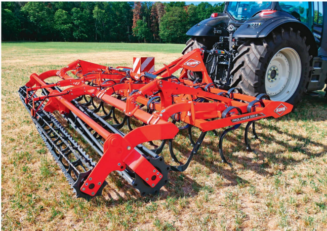
Les cultivateurs de la série «Prolander» sont depuis peu disponibles pour un attelage trois-points avec des largeurs de travail de 4 à 6 m.
