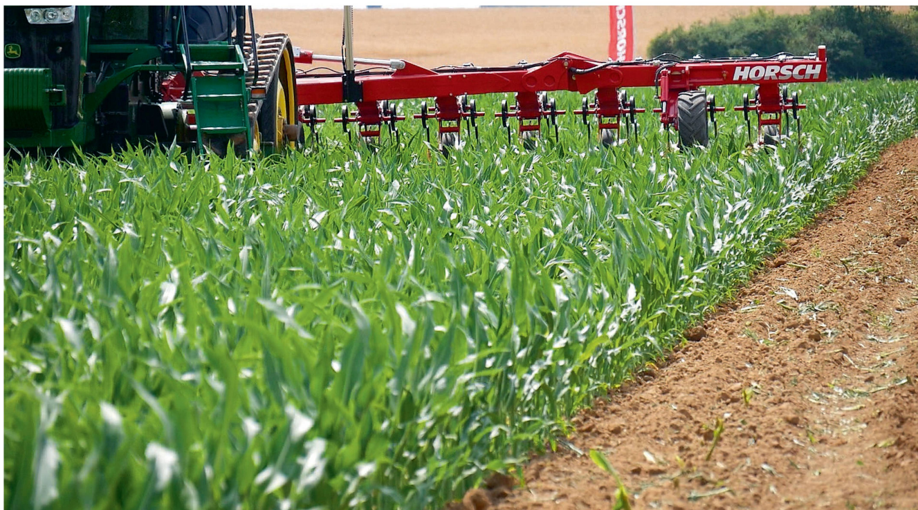
Travailler en grand format, sur une largeur de 12 mètres, avec la bineuse «Transformer 12 VF» guidée par caméra. Photos : Roman Engeler
