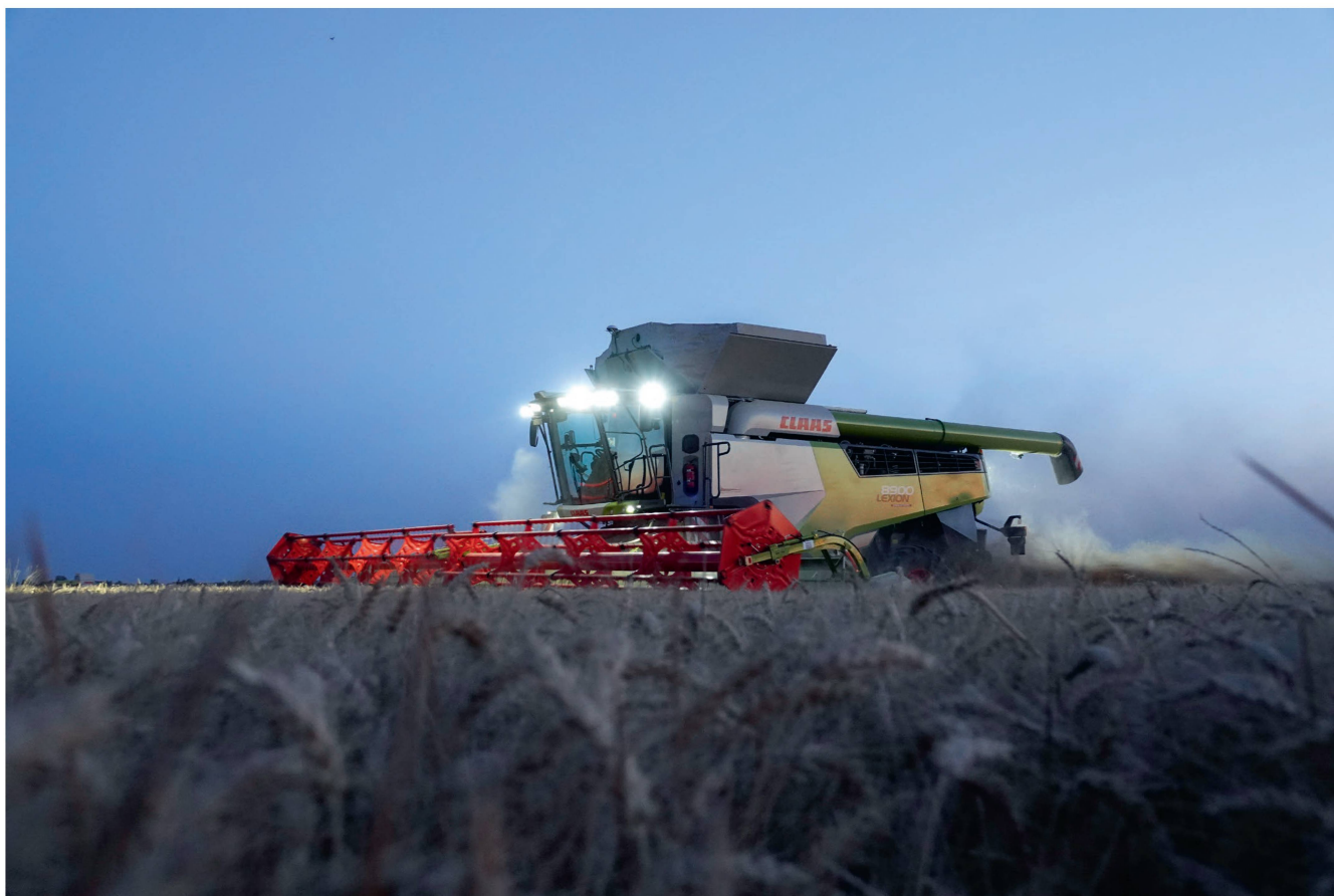
La « Lexion 8900 », vaisseau amiral de la nouvelle gamme, peut être équipée d'une barre de coupe jusqu'à 13,8 mètres. Photos: Ruedi Burkhalter et Idd
