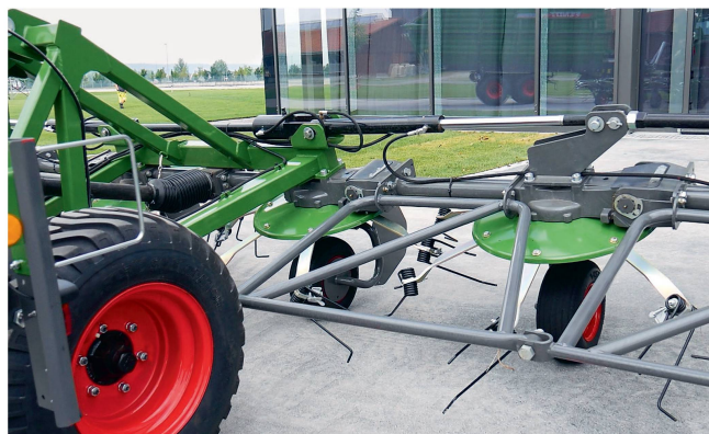
La faneuse «Lotus» de Lely avec ses dents à crochets caractéristiques existe désormais aussi dans la livrée verte typique de Fendt.
