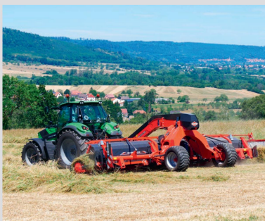
Kuhn propose désormais également l'andaineur à tapis «Merge Maxx» avec une largeur de travail de 7,60 m.
