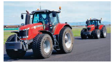
Le tracteur dont les pneus « RoadBib » ont une bande de roulement inédite roule 49 mètres plus loin que les pneus à profil AS.
