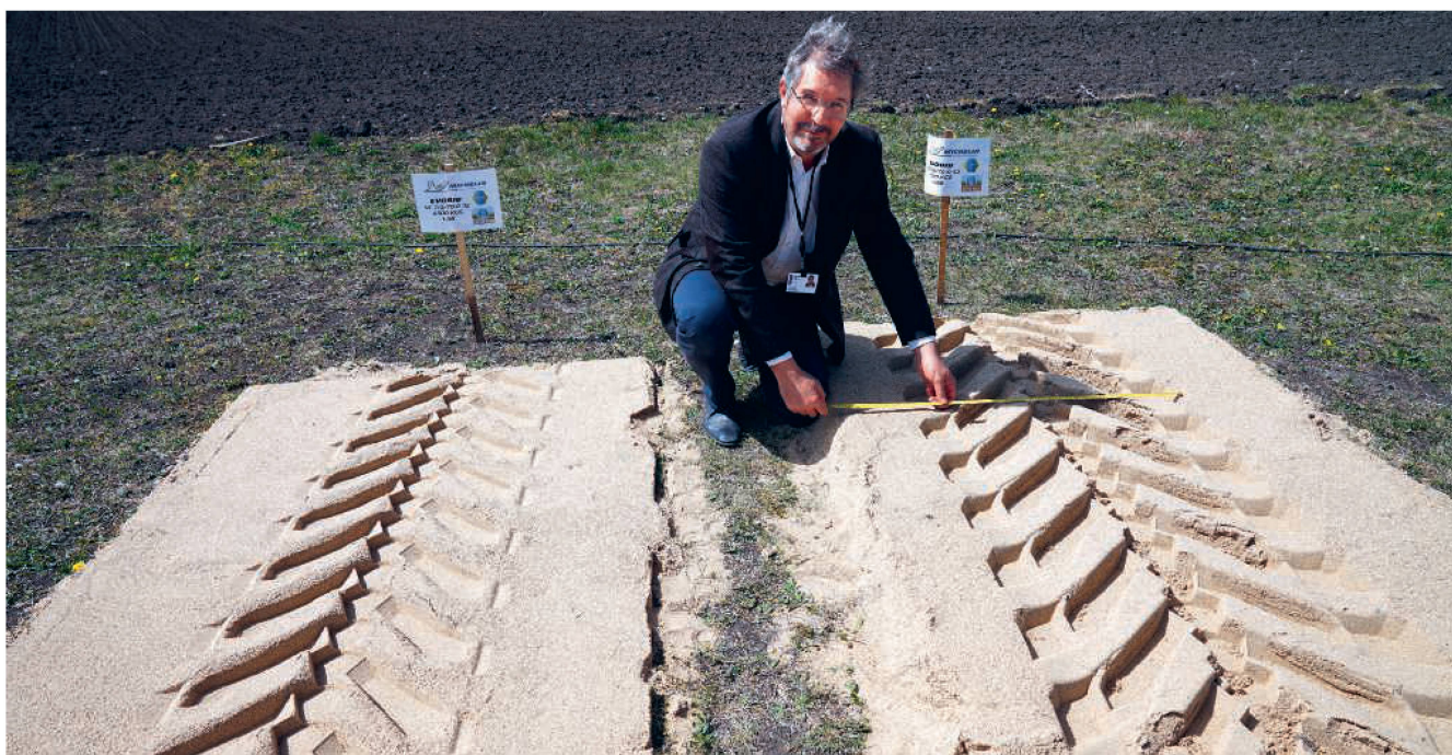
Empreinte du pneumatique «EvoBib» à 1,5 (gauche) et à 0,6 bar: Patrick Vervaeke mesure la surface d'appui qui s'élargit de près de 20 % lorsque la pression est plus basse. Photos: Dominique Senn
