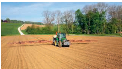
Sur les parcelles avec des passages tracés sans RTK, la gestion individuelle des sections et des buses permet d'éviter les chevauchements aussi bien en bouts de champ et dans les courbes qu'en direction longitudinale.
