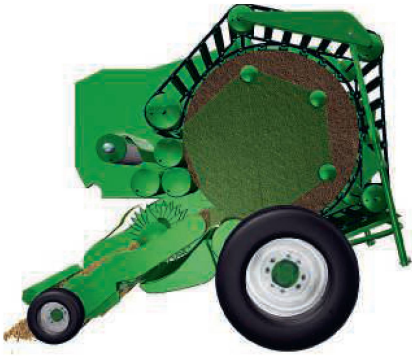
Dans la chambre fixe à diamètre variable, la balle est formée par le « NovoGrip », sorte de convoyeur à barrettes. Elle est d'abord de forme angulaire, puis arrondie.
