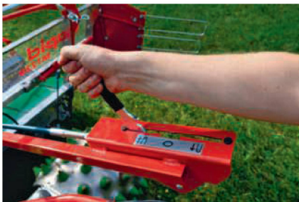
Le changement de direction se fait par un engrenage à inversion sous charge.
