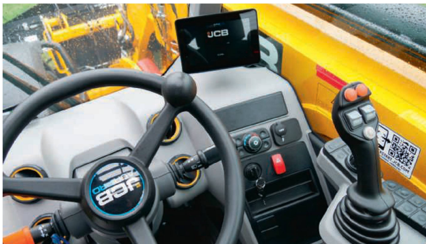
Le cockpit a un nouvel écran de 7 pouces et un joystick électrohydraulique.
