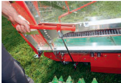
On peut régler les roues de jauge jumelées des deux côtés pour le guidage en profondeur via un levier manuel et une barre perforée.
