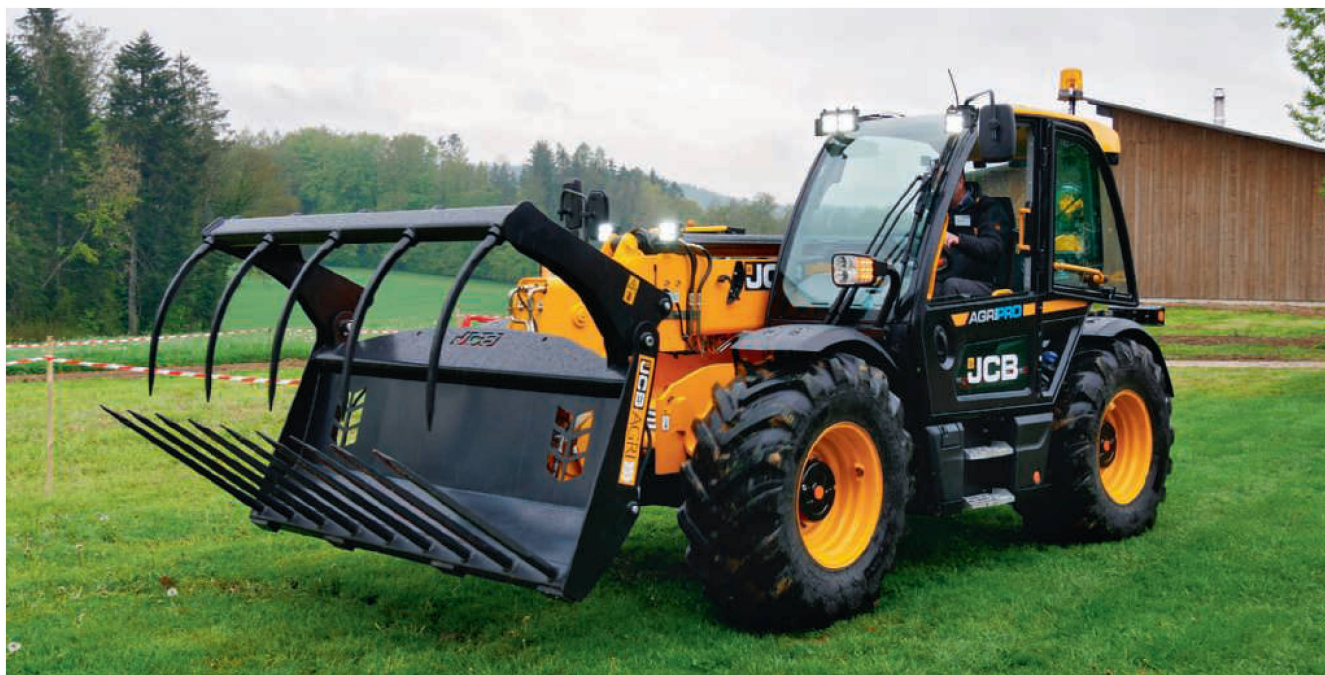
Le « 536-95 AgriPro » de la nouvelle « Série III » a une capacité de levage de 3600 kg et une hauteur de levage de 9,5 m. Photos : Heinz Röthlisberger
