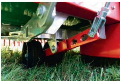
On peut régler les roues de jauge jumelées des deux côtés pour le guidage en profondeur via un levier manuel et une barre perforée.
