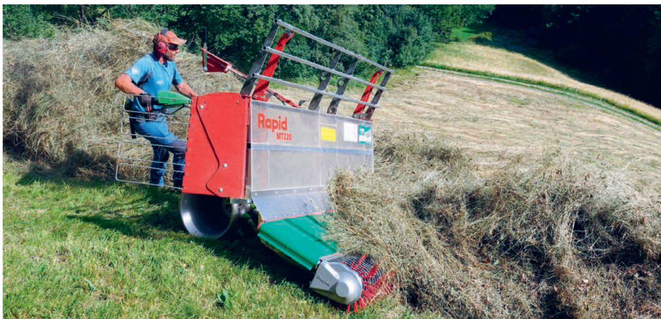
Le «Multi-Twister 220» Rapid pendant le test: le fourrage ramassé par le pickup est transporté activement sur le côté par le convoyeur. Photos: Johannes Paar
