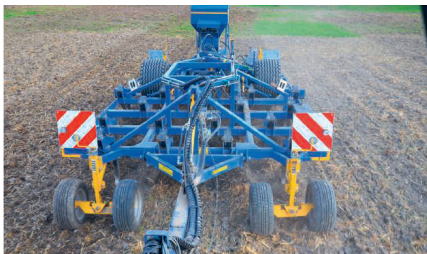
Chisel de précision à 4 poutrelles comporte des roues de jauge antérieures.
