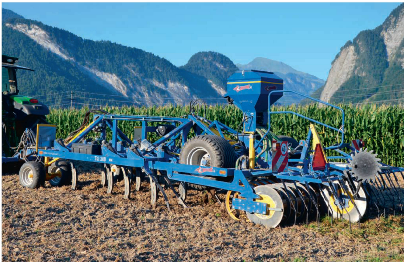
La profondeur précise est assurée par le châssis et le rouleau suiveur. Photos: Ruedi Hunger et Idd
