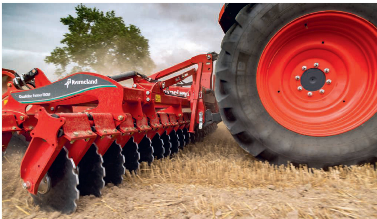
Les disques petits créneaux facilitent la pénétration en terre et permettent en même temps de réaliser un travail superficiel. Photos : Ruedi Hunger
