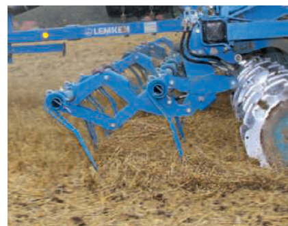
Une étrille montée à l'avant de la déchaumeuse permet de répartir uniformément les résidus de paille. Photo : Lemken
