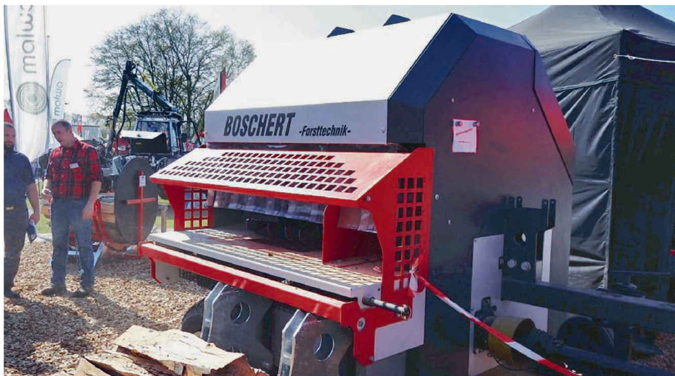
La scie à bois de feu à grand débit Boschert «RS 703 VarioCut» utilise un rotor d'alimentation horizontal et jusqu'à trois lames circulaires.
