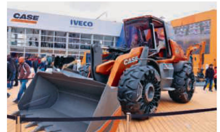
Le projet « Tetra » d'une chargeuse sur pneus avec un moteur à gaz Case équipée des pneus sans air « Tweel » de Michelin
