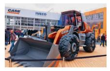
Le projet «Tetra» d'une chargeuse sur pneus avec un moteur à gaz Case équipée des pneus sans air «Tweel» de Michelin
