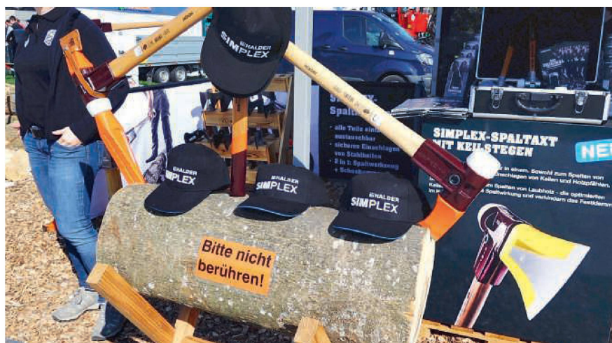
Le « Simplex » réunit masse synthétique et hache ou merlin en un seul outil.
