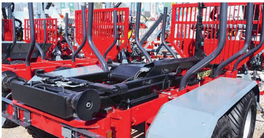
En dotant sa remorque d'un bras de levage à crochet, Engel Forsttechnik lui permet d'être utilisée à des fins diverses, toute l'année.
