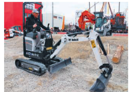
Petite et électrique : la première mini-pelle mécanique entièrement électrique « E10e » de Bobcat, classe 1 tonne, sans déport arrière.
