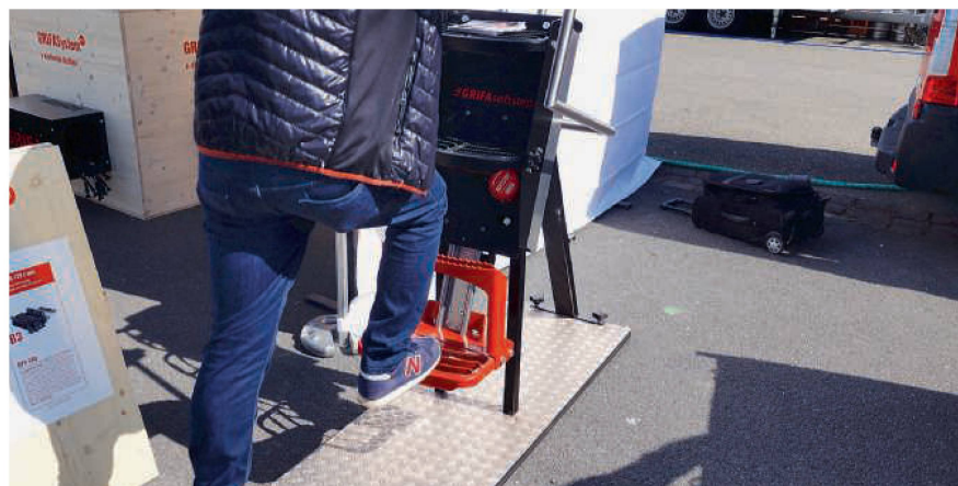
Le marchepied dynamique «Grifa softstep» remonte lorsqu'on pose le pied sur la marche.
