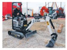
Petite et électrique: la première mini-pelle mécanique entièrement électrique «E10e» de Bobcat, classe 1 tonne, sans déport arrière.
