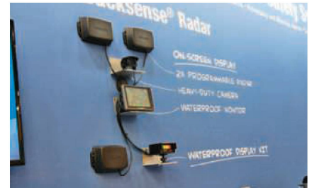
Système d'alerte radar « Backsense » de Brigade-Elektronik avertissant les conducteurs de la présence d'obstacles en mouvement ou fixes avec des alarmes différenciées.
