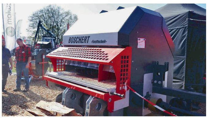
La scie à bois de feu à grand débit Boschert «RS 703 VarioCut» utilise un rotor d'alimentation horizontal et jusqu'à trois lames circulaires.
