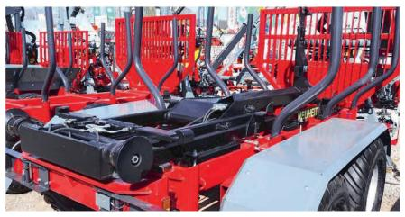
En dotant sa remorque d'un bras de levage à crochet, Engel Forsttechnik lui permet d'être utilisée à des fins diverses, toute l'année.
