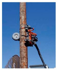
Avec le «Patas», Advaligno redéfinit l'élagage sylvicole. L'opération d'élagage complète d'un arbre est achevée en 8 secondes.
