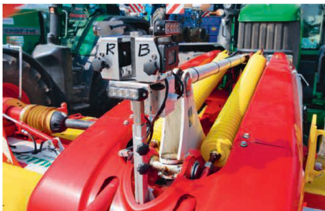
Le système de caméras «VKMS» et ses clignotants sur un dispositif d'attelage rapide Remund+Berger.
