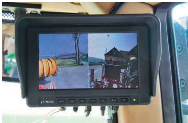
L'écran Motec affiche les images des deux caméras bien distinctes, sur un appareil de 7 pouces.
