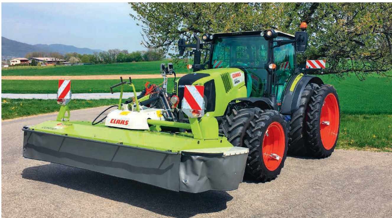
En Suisse, un système caméra-moniteur homologué est obligatoire lorsque les équipements dépassent de plus de 4 mètres vers l'avant du tracteur. Photos: Heinz Röthlisberger et Idd
