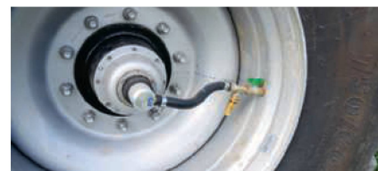
Associés au dispositif de réglage de pression embarqué, les pneumatiques 750 assurent une protection maximale des sols.
