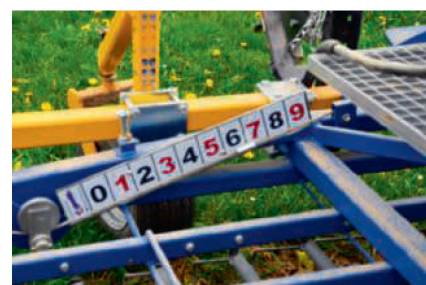
Le conducteur peut choisir la prétension des ressorts à l'aide d'une échelle comportant des nombres inscrits en grands caractères.
