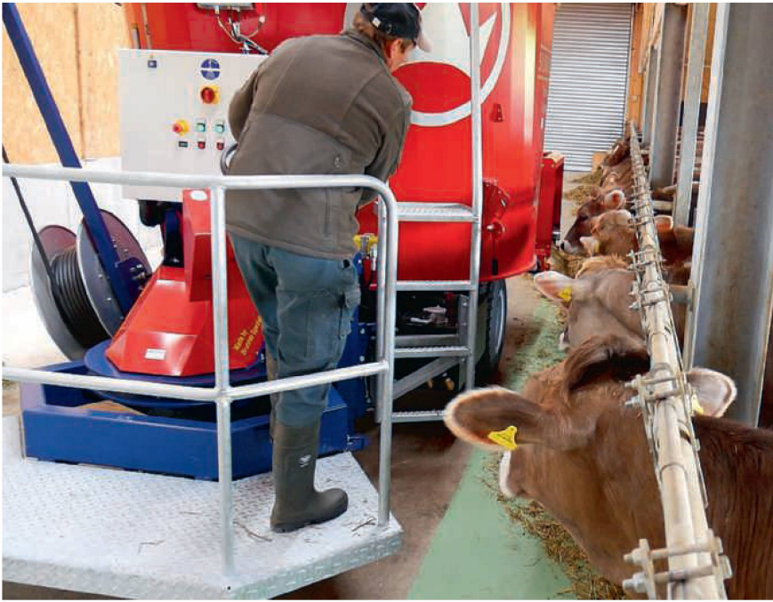
L'unité de commande avec son volant peut pivoter vers la gauche et vers la droite. Photos: Roman Engeler
