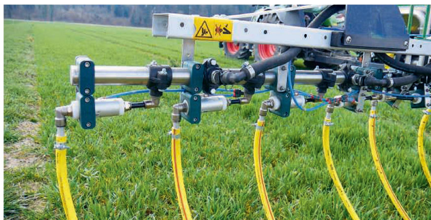
La rampe de pulvérisation est pourvue de vannes à manchon en acier inoxydable qui remplacent les buses.
