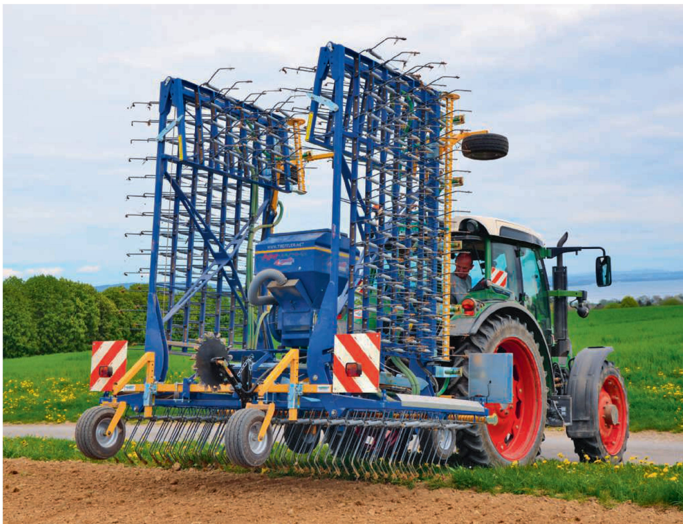
Cette herse-étrille de Treffler se distingue par sa largeur de travail de 9 mètres, ses cinq ressorts, son châssis à six roues et son semoir.
