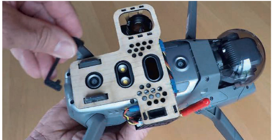
Rassemblés sur une console ultralégère, la caméra, l'émetteur et son antenne se montent d'un bloc sous le drone.
