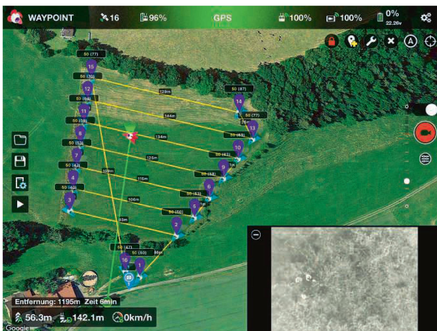
Un plan de vol avec points de passage (« waypoints ») selon la méthode HAFL, qui permet un survol automatique par un drone.
