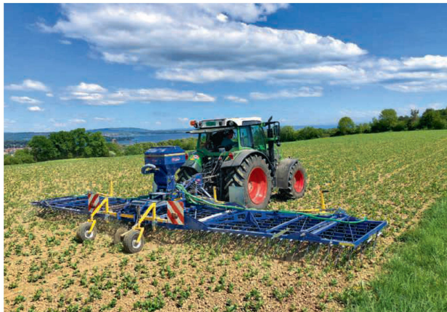
Les roues de jauge assurent un guidage en profondeur régulier de la machine sur une largeur de travail de 9 mètres.
