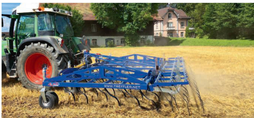
Les dents vibrantes en acier à profil plat et le châssis massif caractérisent ce vibroculteur.
