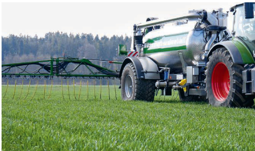
La citerne à pompe épand l'engrais avec 10 tronçons et en tout 60 soupapes dans des tuyaux fins proches du sol et réduisant les émissions. Photos : Roman Engeler
