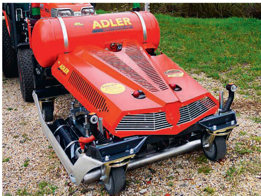
Les désherbeurs à infrarouge peuvent être dirigés à la main ou utilisés en tant qu'outils portés sur un monoaxe ou un tracteur. Photo: Adler
