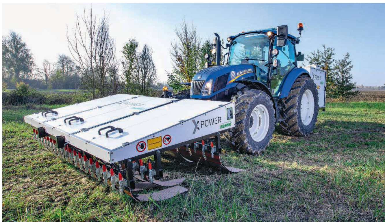
CNHi annonce la commercialisation «à partir de 2019» de la technologie X-Power de désherbage par circulation de courant électrique dans le sol. Photo: CNH/Zasso
