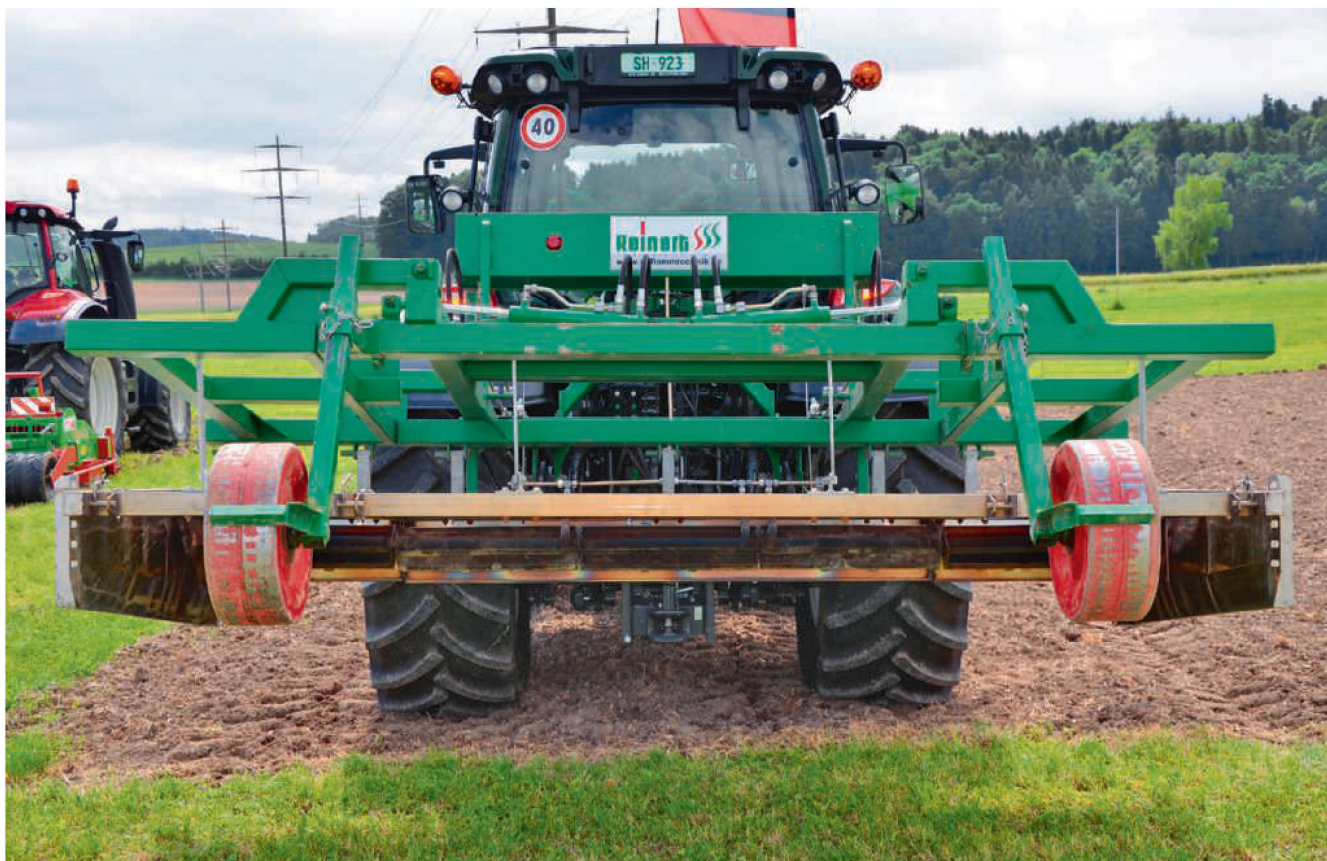
Le brûlage est un procédé pouvant se substituer au désherbage chimique. Photo: Ruedi Hunger
