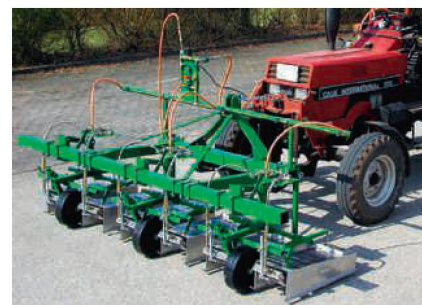
Les appareils thermiques portés à l'avant et aptes à traiter les cultures sur butte sont plutôt rares. Photo: Reinert
