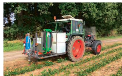
Traitement des bordures à l'eau bouillante, celle-ci pouvant aussi être combinée à la vapeur. Photo: Keckex
