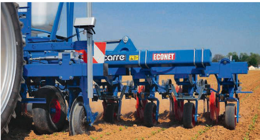
La caméra donne des images contribuant au guidage précis de l'appareil le long des rangées de plantes. Photo: Carré
