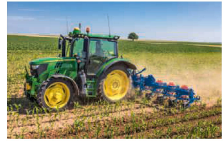
L'outil est guidé par GPS via un dispositif hydraulique de déplacement latéral des bras inférieurs. Photo: John Deere
