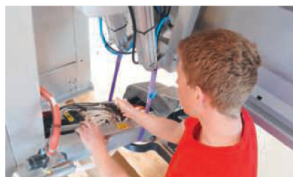
Tous les composants du pulsateur sont remplacés et testés.
