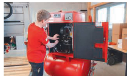
Composant important du robot, le compresseur à air, sans huile, est aussi révisé.
