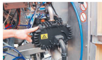
La capacité de la pompe à vide est vérifiée. Elle est remplacée au besoin.
