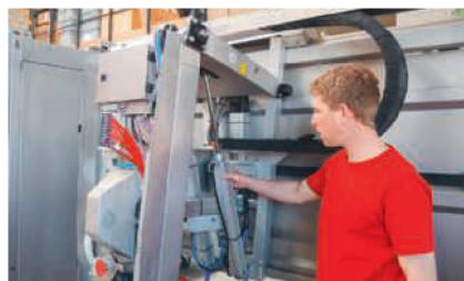
Tous les vérins pneumatiques sont étanchéifiés et testés.
