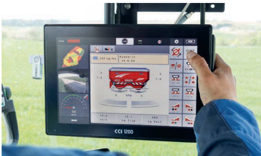
Le « CCI 1200 » est doté d'un écran suffisamment grand pour afficher simultanément plusieurs applications. Photos : CCI
