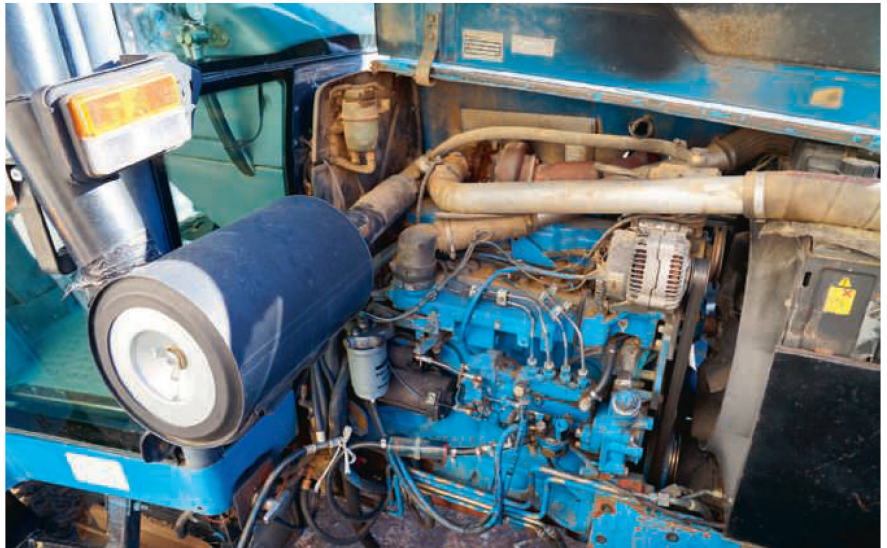
On distingue au premier plan le filtre à air, la pompe à injection en ligne Bosch et, au-dessus, le tuyau d'alimentation du turbo.
