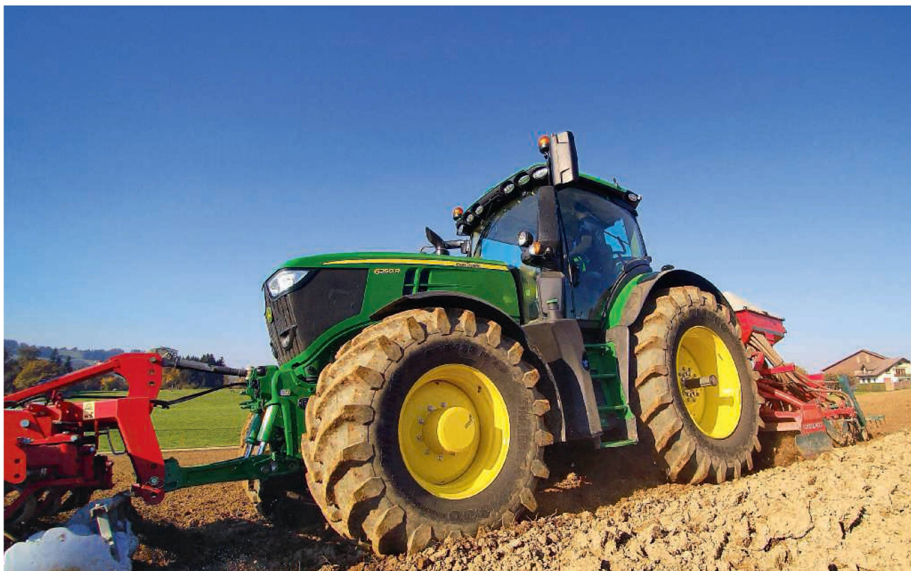
Un tracteur devrait être aussi léger que possible, mais aussi lourd que nécessaire pour transmettre la force de traction au sol avec un patinage réduit. Photo: Roman Engeler
