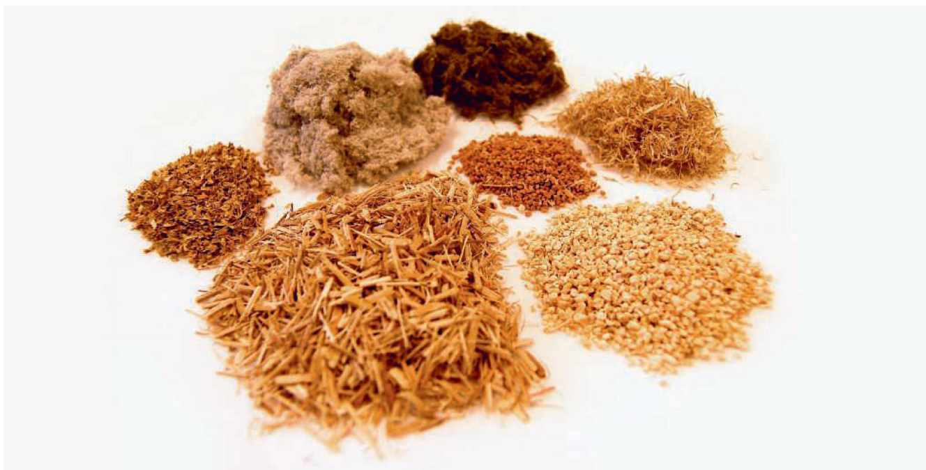
Ces résidus agricoles, la vannure d'épeautre, les rafles de maïs, la paille ou le miscanthus, peuvent servir à fabriquer des bioplastiques. Photos: IfBB
