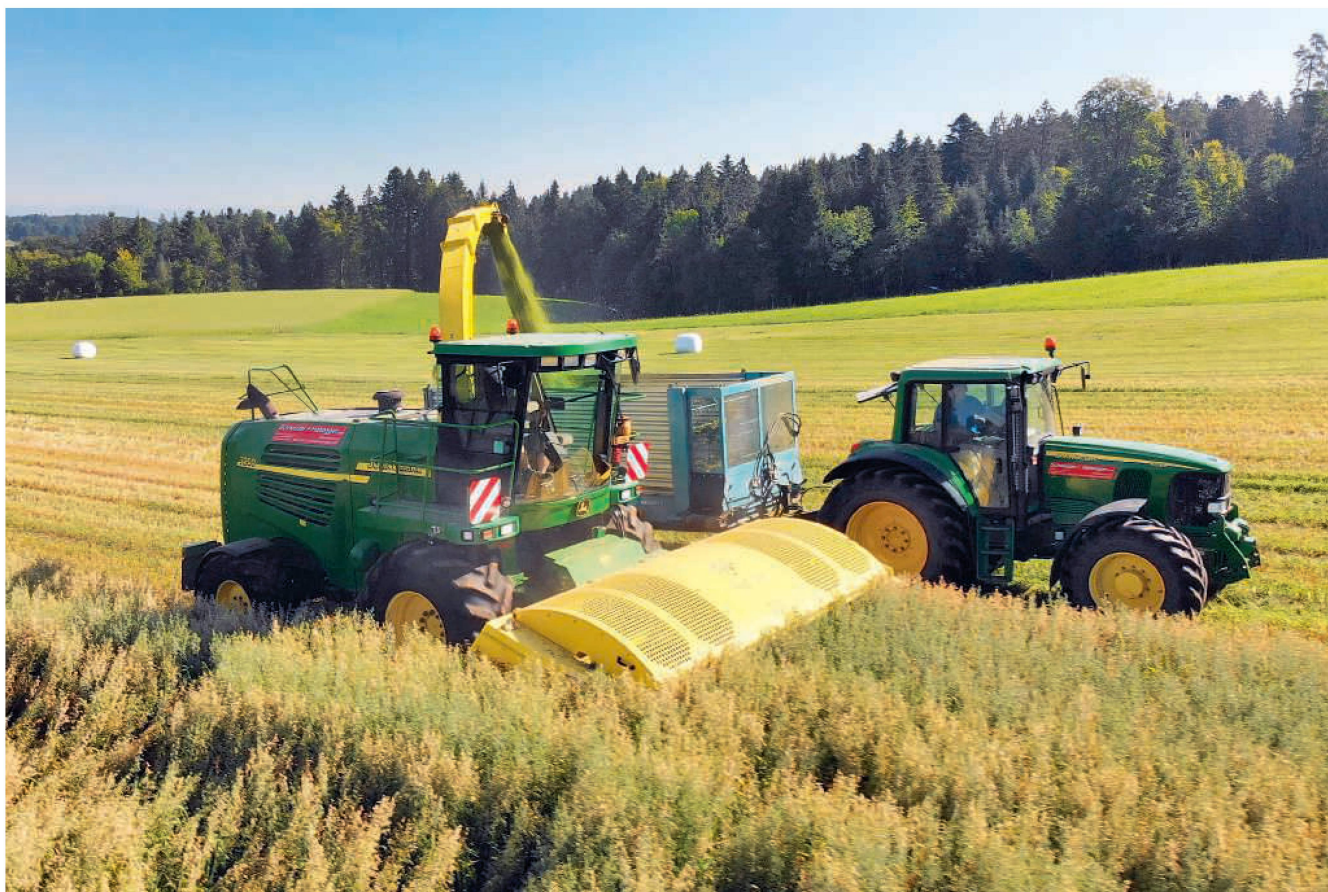
La récolte avec tête de coupe directe permet d'éviter toute souillure par contact avec le sol. Photos : Ruedi Burkhalter
