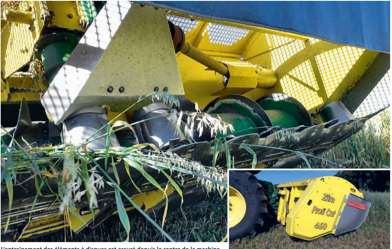
L'entraînement des éléments à disques est assuré depuis le centre de la machine.
