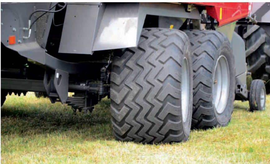
Les roues montées sur un essieu directeur ménagent la couche herbeuse.
