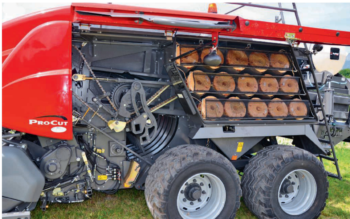
La presse possède une chambre de précompression, qui contribue à augmenter la densité des balles et améliore leur forme.
