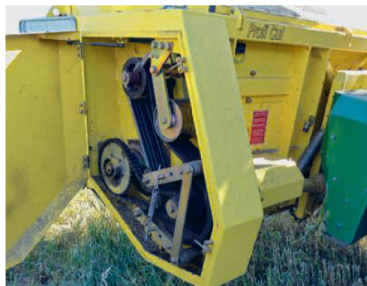
Le train de courroies latéral est muni d'un embrayage de sécurité à friction.
